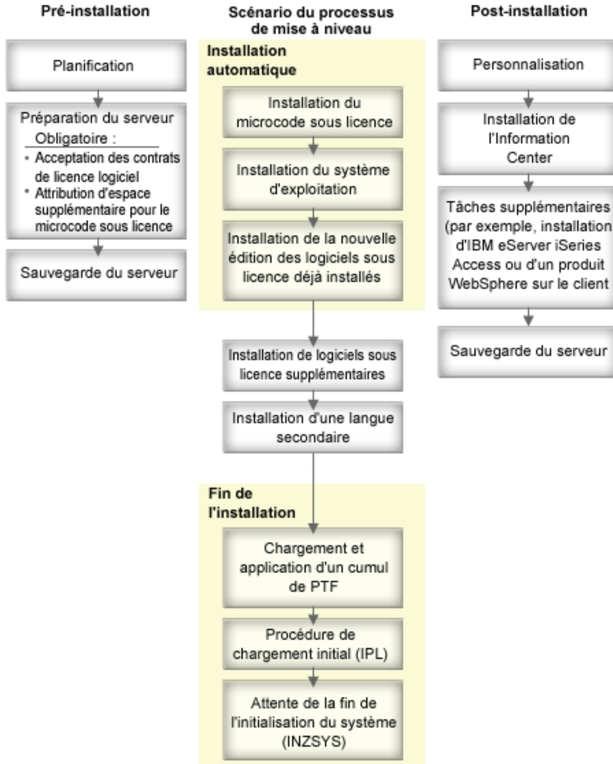
Figure 1. Présentation de la procédure d'installation
