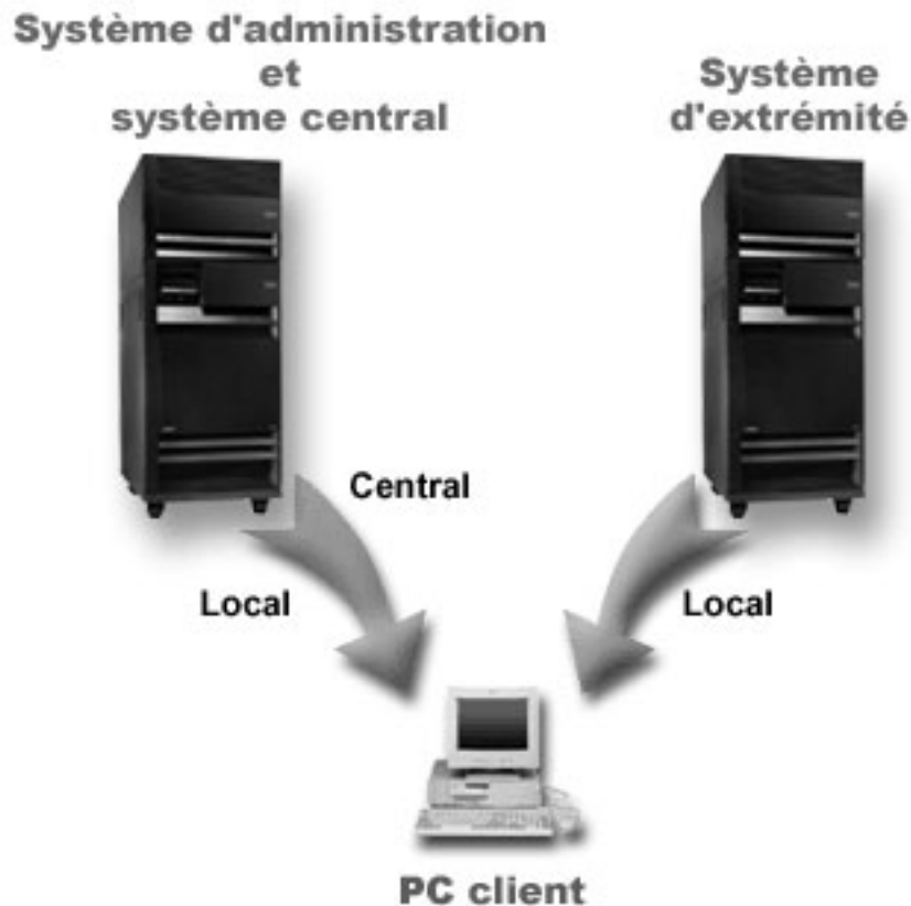
Figure 3. Le même serveur peut être utilisé à la fois comme système d'administration et comme système central. Ceci ne modifie pas le fonctionnement des composants Administration d'application et Gestion centralisée. Lorsqu'un PC client se connecte à un système, les paramètres de gestion locale proviennent de ce système. Lorsque vous vous connectez à un système d'administration, les paramètres de gestion centralisée sont envoyés à votre PC client à partir de ce système d'administration.
