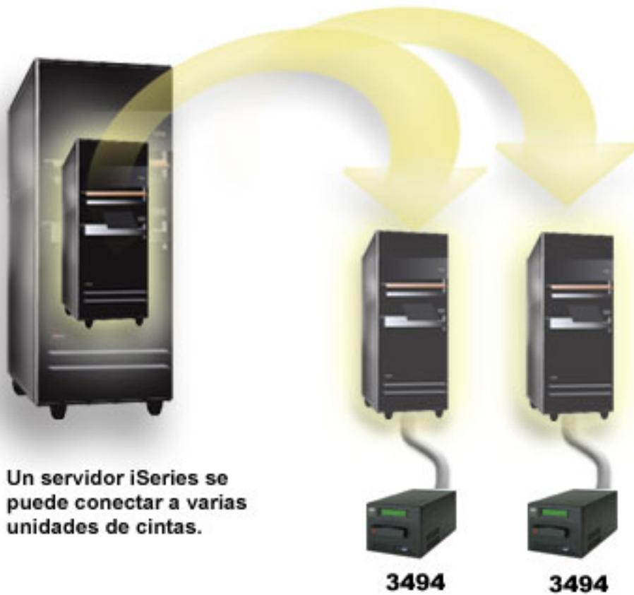
La figura siguiente muestra una configuración para la que no hay soporte. El cable conecta el servidor iSeries a las unidades de cinta.
