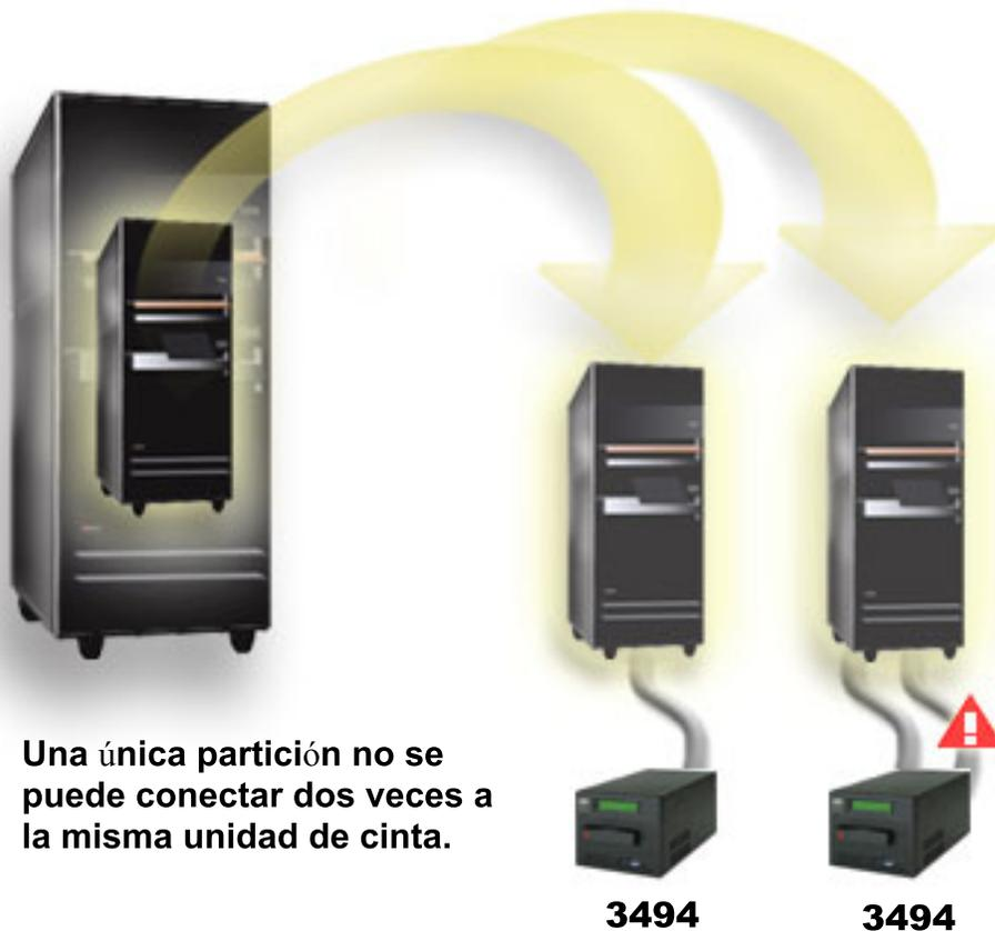
Figura 2. Configuración sin soporte
