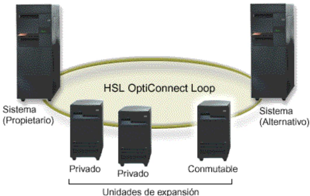
Figura 2. La unidad de expansión más alejada del servidor propietario en el segmento del bucle se ha convertido en conmutable.
