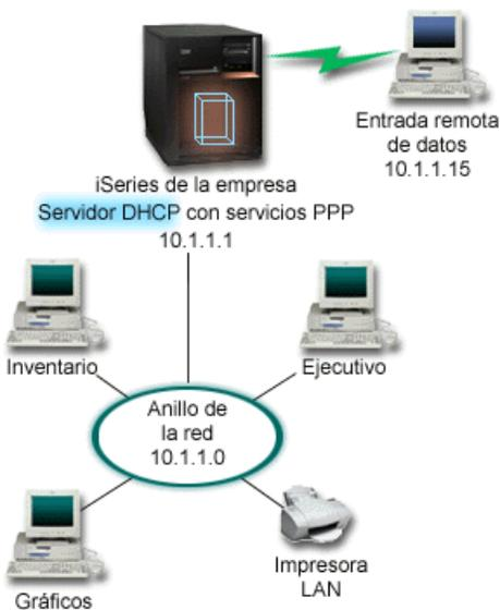
Figura 8. PPP y DHCP en un solo servidor iSeries
