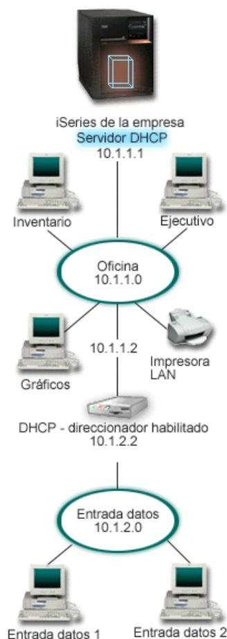
Figura 3. Varias LAN conectadas a través de un direccionador
