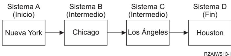
Esta figura muestra las conexiones que establece Janice Lowe. El servidor iSeries desde el que inicia el trabajo en Nueva York se denomina sistema inicial. Desde ahí se conecta al sistema intermedio B de Chicago y, a continuación, se conecta al sistema intermedio C de Los Ángeles, que se conecta al sistema final D de Houston.
