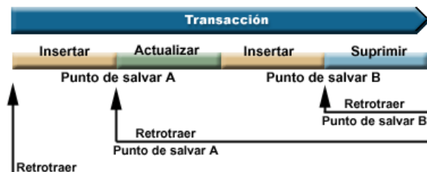
Figura 1: cómo se utilizan los puntos de salvar para controlar las retrotracciones en una transacción
