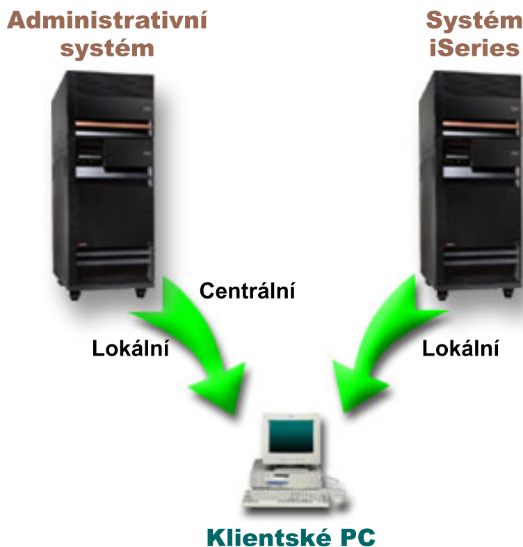
Obrázek 1. Když se klientský PC připojuje k systému, získá Lokální nastavení ze systému, ke kterému se připojuje. Když se připojíte k administrativnímu systému, budou vám na váš klientský PC poslána Centrální nastavení z administrativního systému.
