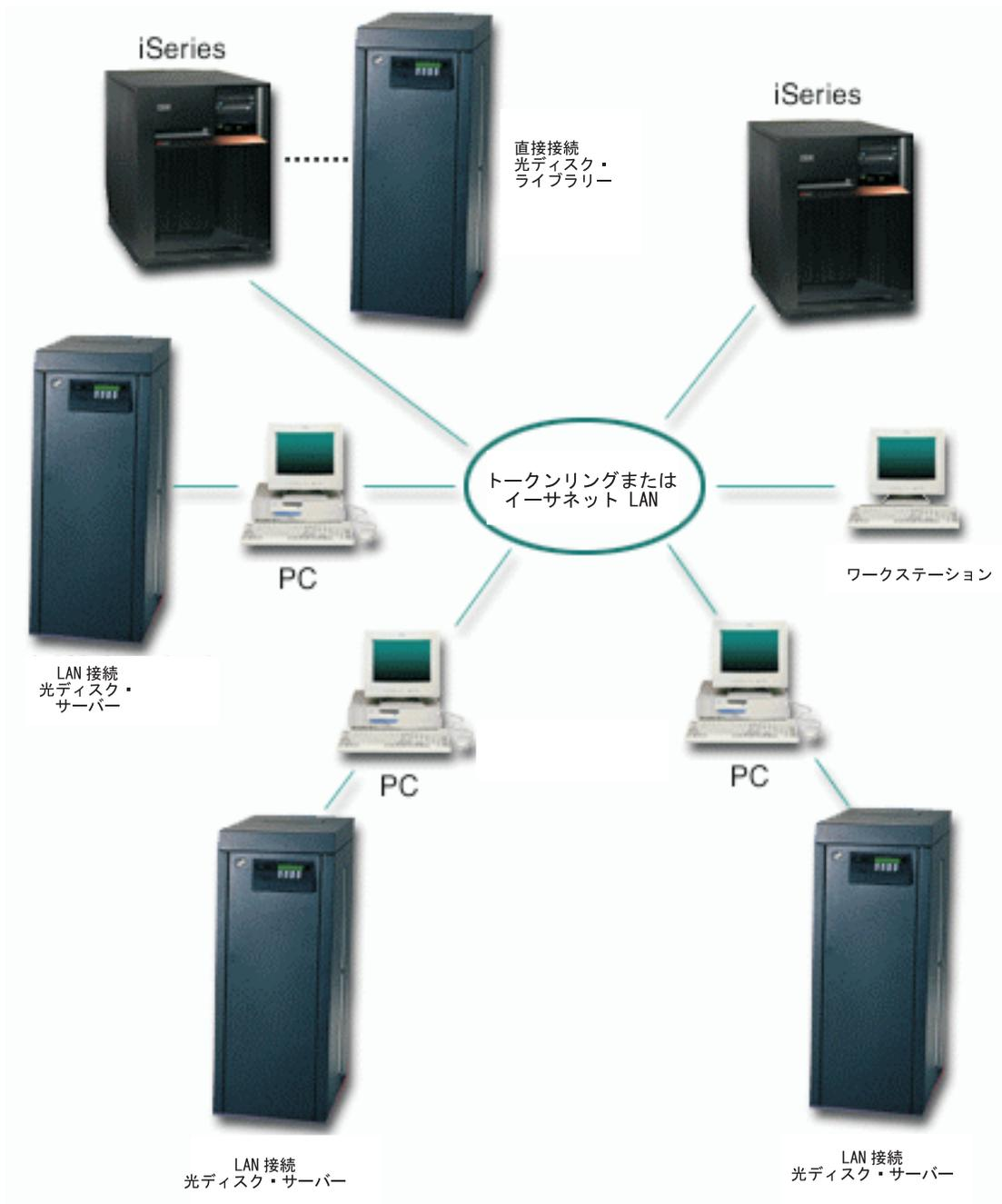
図9. 一般的な光ディスク LAN 構成
