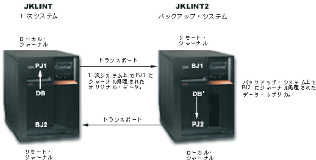
手順を簡略化するために、以下の例では、DB を1つのデータベース・ファイルとし、DB' をそのレプリカとしています。
