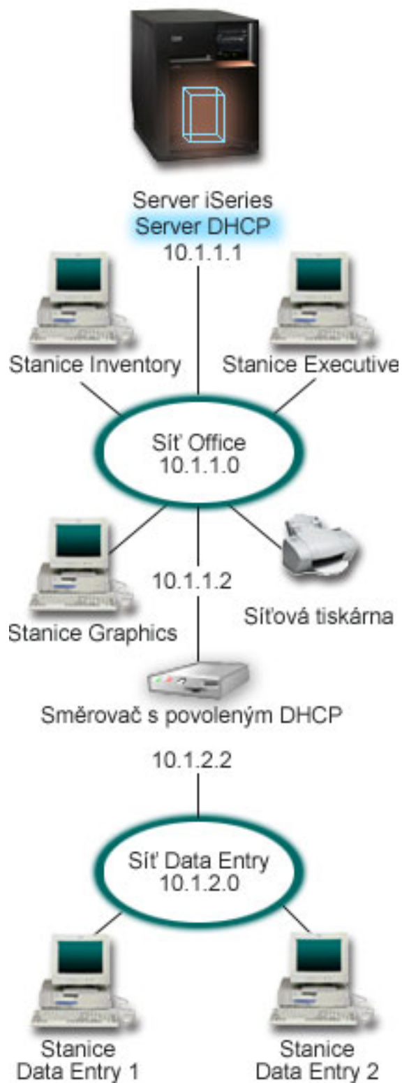
Obrázek 3-1. Vícenásobné síť LAN spojené prostřednictvím směrovače
