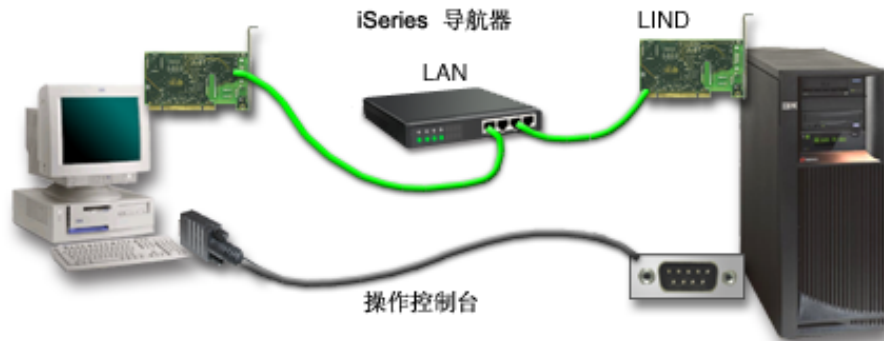
图 1. 独立连接的 iSeries 导航器和操作控制台配置
