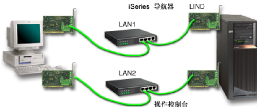
图 3. 在不同的网络上的 iSeries 导航器和操作控制台配置
