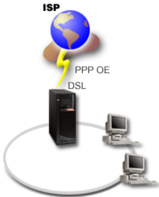
Obrázok 1. Pripojenie vášho servera iSeries k ISP pomocou PPPoE
