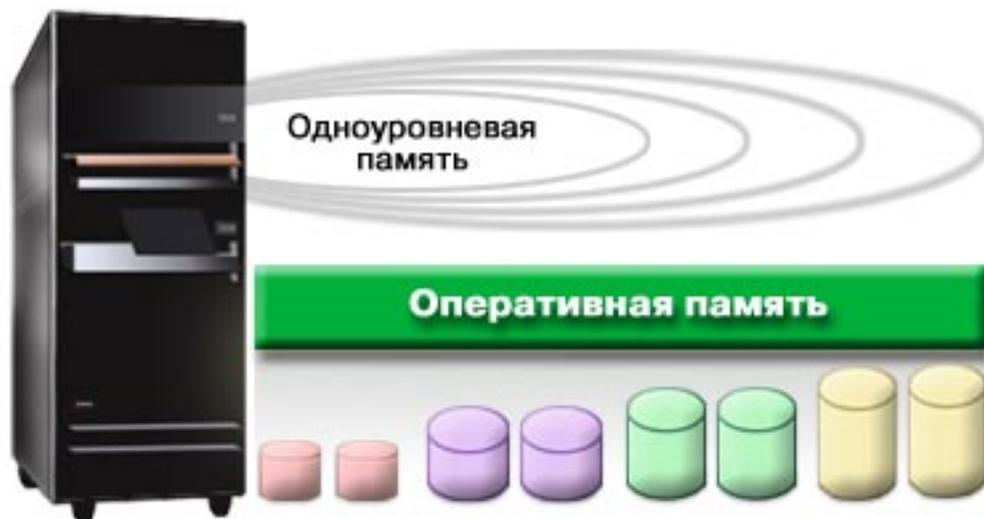
При сохранении файла сервер самостоятельно выбирает его расположение для достижения максимальной производительности. Например, файл может быть распределен по нескольким жестким дискам. По мере увеличения размера файла ему выделяются дополнительные области памяти.
