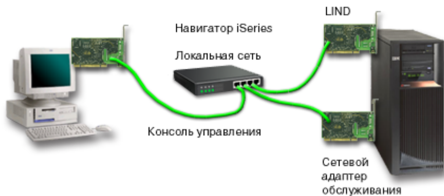
Рисунок 2. Конфигурация с общей сетью для Навигатора iSeries и Консоли управления
