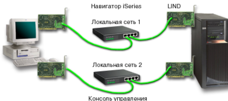
Рисунок 3. Конфигурация с различными сетями для Навигатора iSeries и Консоли управления
