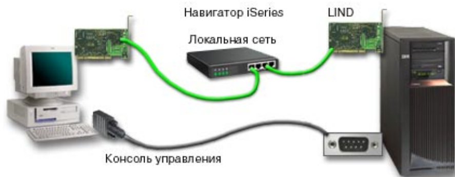
Рисунок 1. Конфигурация с отдельными соединениями для Навигатора iSeries и Консоли управления
