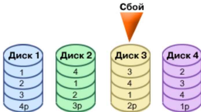
Рисунок 3. Набор устройств с проверкой четности, содержащий неисправный диск
