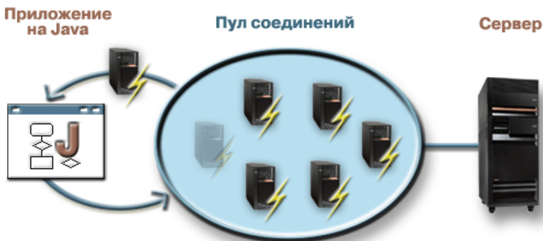
Рис. 3: Программа на Java, применяющая соединение с сервером iSeries из пула AS400ConnectionPool
