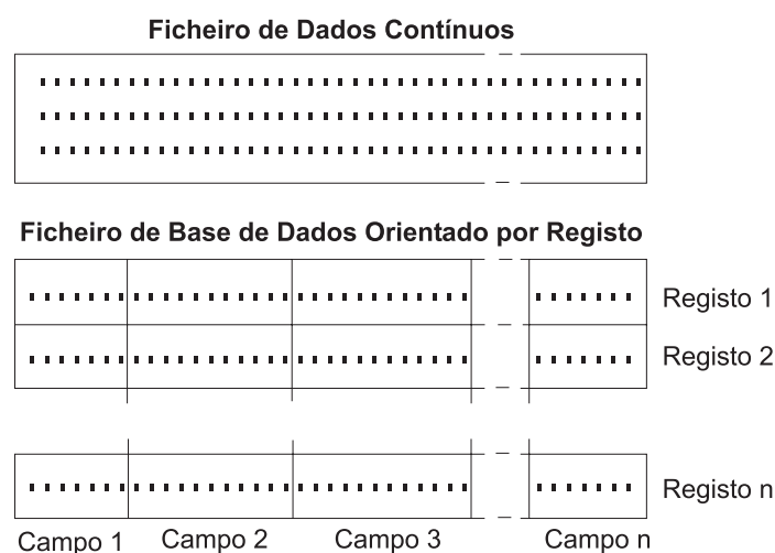
Figura 3. Comparação de um ficheiro de dados contínuos com um ficheiro orientado para registos
