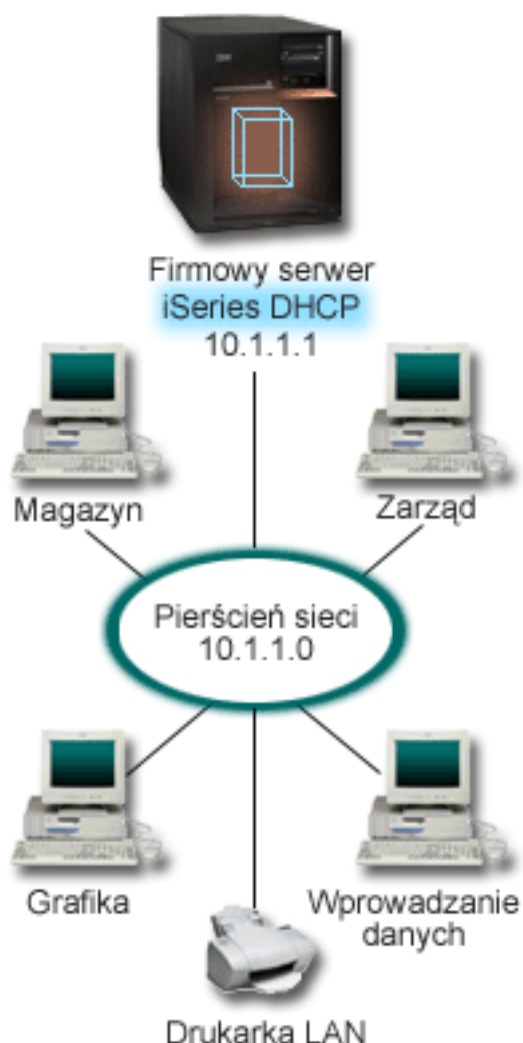
Rysunek 2-1. Konfiguracja serwera iSeries na potrzeby prostej sieci lokalnej.
