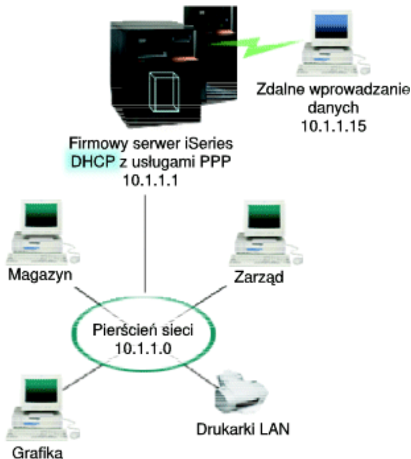
Rysunek 7-1. PPP i DHCP na jednym serwerze iSeries.
