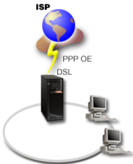
Rysunek 1. Połączenie serwera iSeries do dostawcy ISP przy użyciu PPPoE
