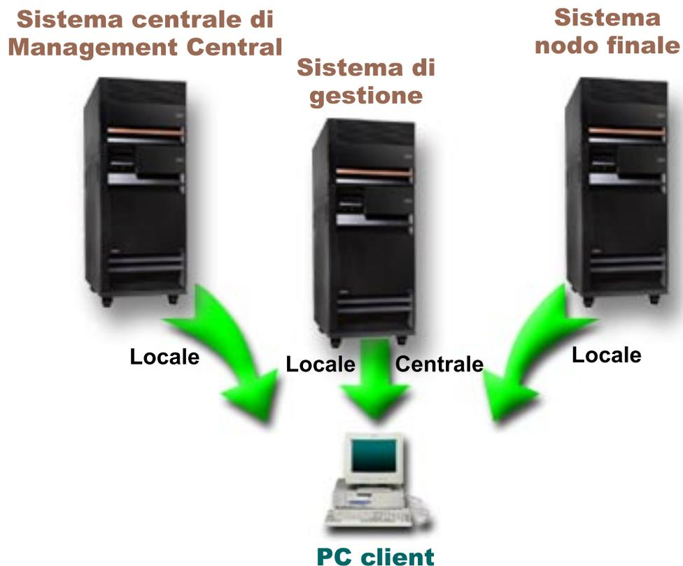
Figura 2. Quando un PC client si collega ad un sistema, le Impostazioni locali vengono dal sistema a cui ci si collega. Quando si effettua il collegamento ad un sistema di gestione, le Impostazioni centrali vengono inviate al proprio PC client dal sistema di gestione. Questa rete non modifica la funzione di Gestione applicazioni o di Management Central.
