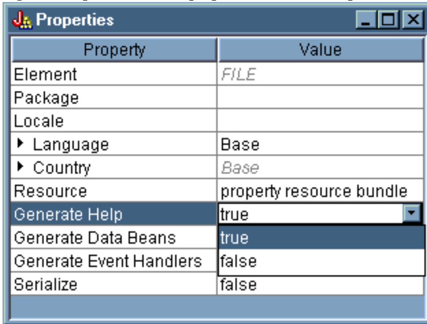
Figura 1: impostazione della proprietà Crea aiuto sul pannello delle proprietà del GUI Builder
