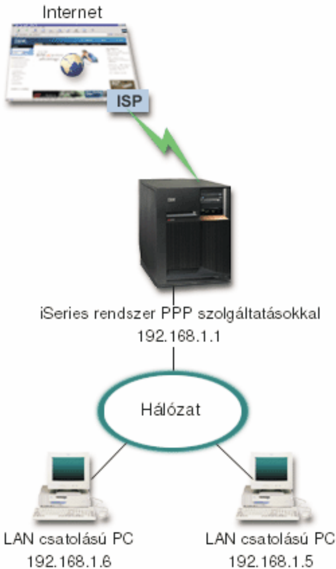
Ábra: 3. Az irodai LAN kapcsolódása az Internethez modem segítségével
