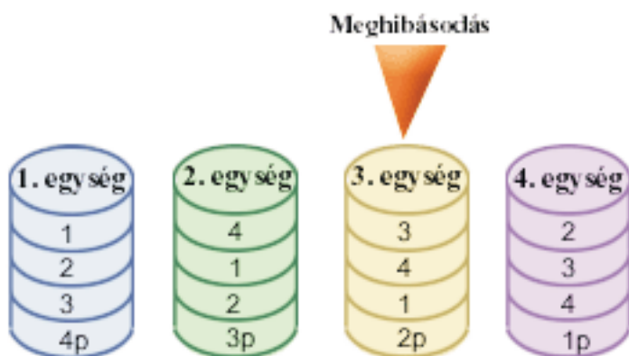
Ábra: 3. Eszköz paritáskészlet meghibásodott lemezegységgel
