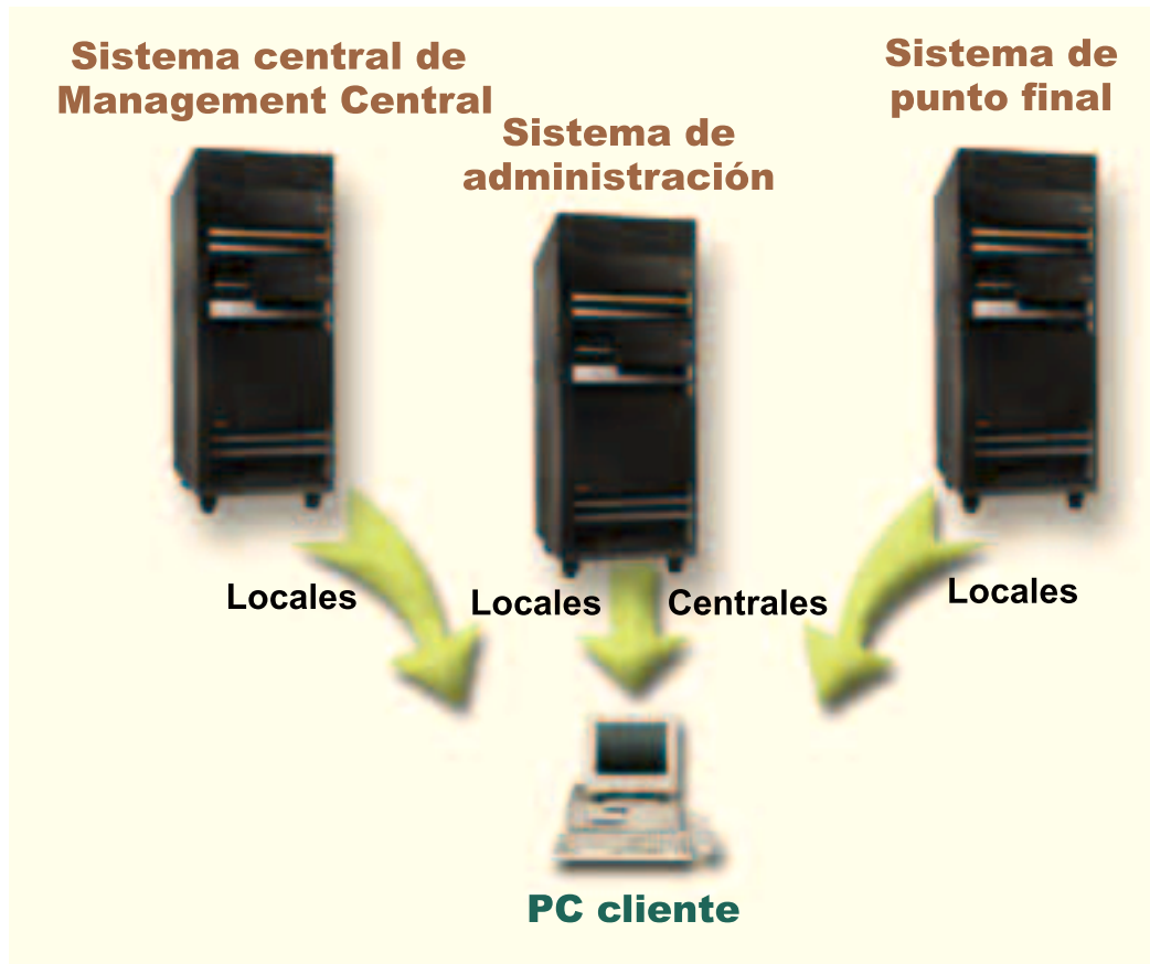
Figura 2. Cuando un PC cliente se conecta a un sistema, los valores locales proceden del sistema al que se haya conectado. Si usted se conecta a un sistema de administración, los valores centrales se envían desde el sistema de administración a su PC cliente. Esta red no cambia la función de Administración de Aplicaciones ni de Management Central.
