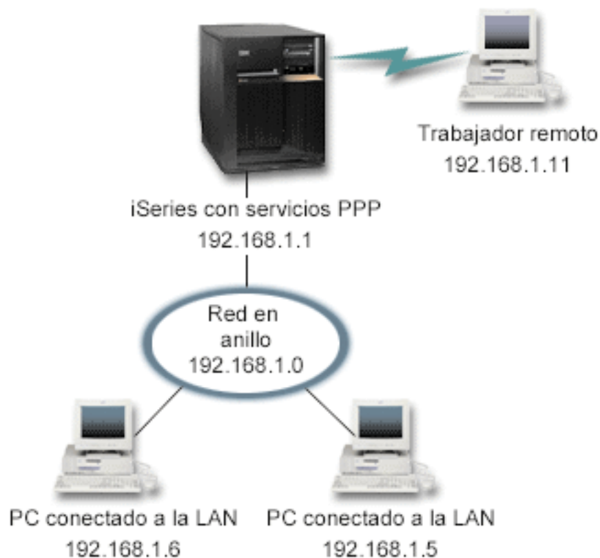
Figura 1. Conectar clientes remotos al servidor iSeries
