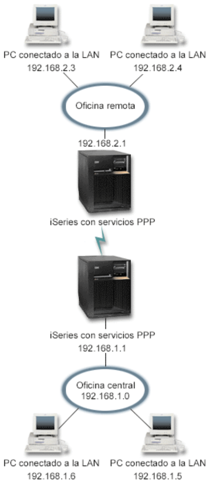
Figura 3. Conectar las redes corporativa y remota con un módem
