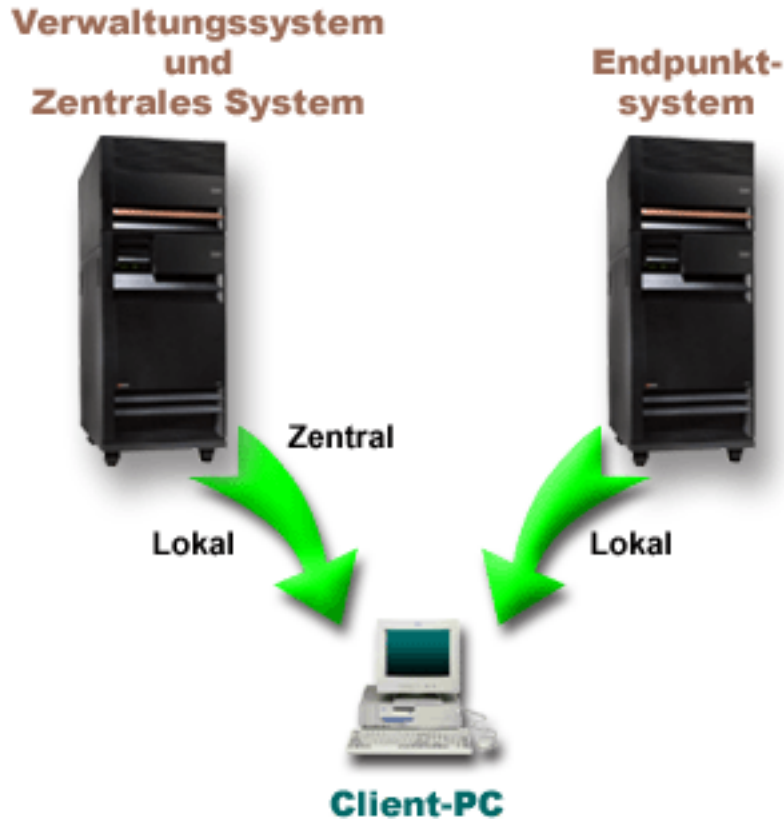
Abbildung 3. Ein System kann gleichzeitig Verwaltungssystem und zentrales System sein. Die Funktionsweise der Anwendungsverwaltung oder von Management Central ändert sich nicht. Sobald ein Client-PC eine Verbindung zu einem System herstellt, werden die lokalen Einstellungen von dem System übernommen, zu dem die Verbindung besteht. Wird eine Verbindung zu einem Verwaltungssystem hergestellt, werden die zentralen Einstellungen vom Verwaltungssystem an den Client-PC gesendet.
