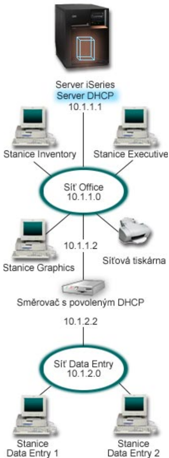
Obrázek 3-1. Vícenásobné sítě LAN spojené prostřednictvím směrovače
