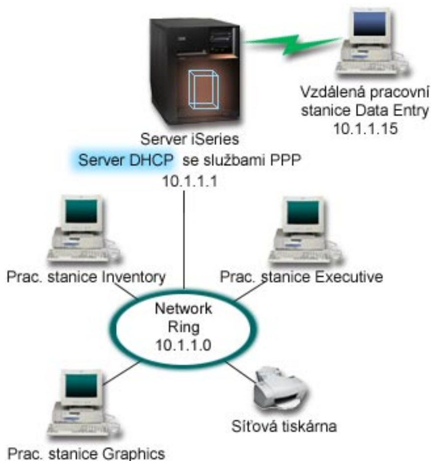
Obrázek 7-1. PPP a DHCP na jednom serveru iSeries
