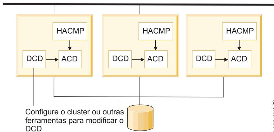
Figura 19. Relacionamento do PowerHA SystemMirror com o ACD quando um cluster é iniciado.
