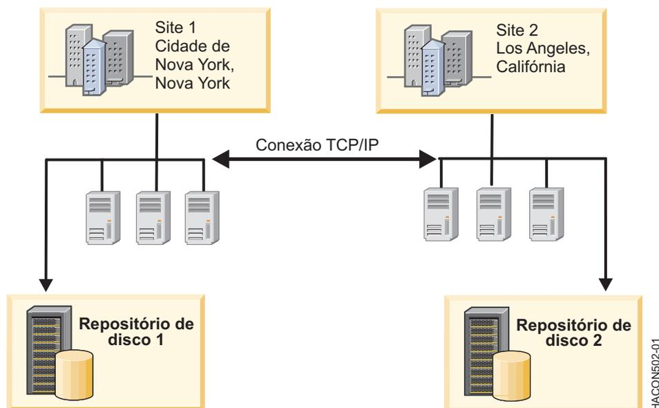
Figura 5. Configuração típica de cluster vinculado
