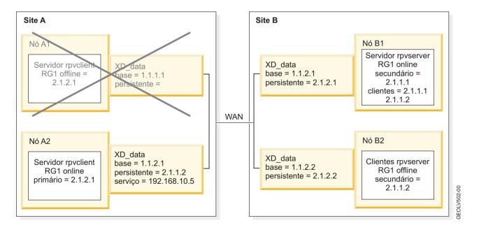
A figura a seguir mostra a configuração do GLVM após o grupo de recursos cair para o outro site e permanecer ativo lá. Nesse ponto, os nós com falha no site com falha se uniram novamente ao cluster.
