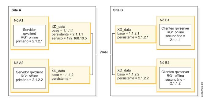
Na configuração inicial do cluster do GLVM, o RPVclient para o nó A1 está ligado ao endereço IP persistente 2.1.1.1 e usa o RPVserver no nó B1, que está ligado ao endereço IP persistente 2.1.2.1. A configuração correspondente é verdadeira para os nós A2 e B2, em que o RPVclient no nó A2 usa o RPVserver no nó B2.
