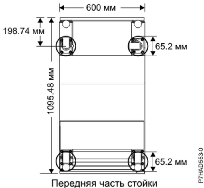
Рисунок 7. Расположения роликов
