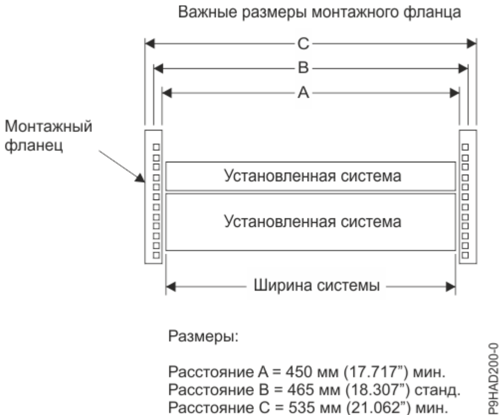
Рисунок 48. Критически важные размеры монтажных фланцев
