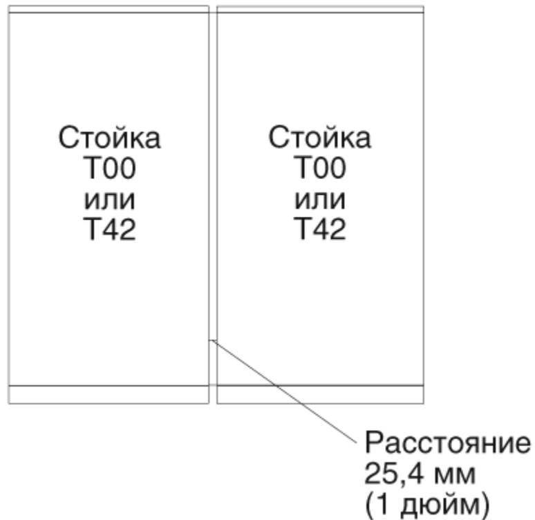
Для соединения стоек можно заказать комплект болтов, вставок и декоративных накладок, закрывающих зазор шириной 25,4 мм. Размеры пространства для обслуживания приведены в таблице для стойки модели 7014-T00.
