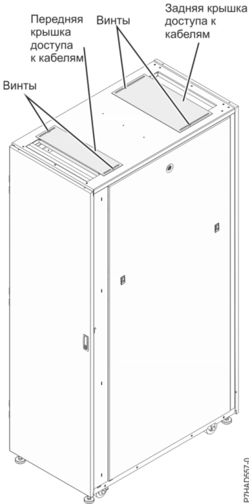
Рисунок 12. Крышки доступа к кабелям
