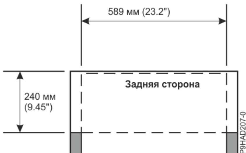
Рисунок 35. Зазор сзади для стойки моделей 9080-M9S
