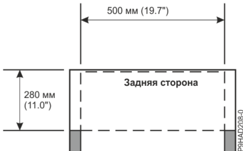
Рисунок 36. Зазор сзади для стойки моделей 9080-M9S (установка стойки с помощью узкой скобы)
