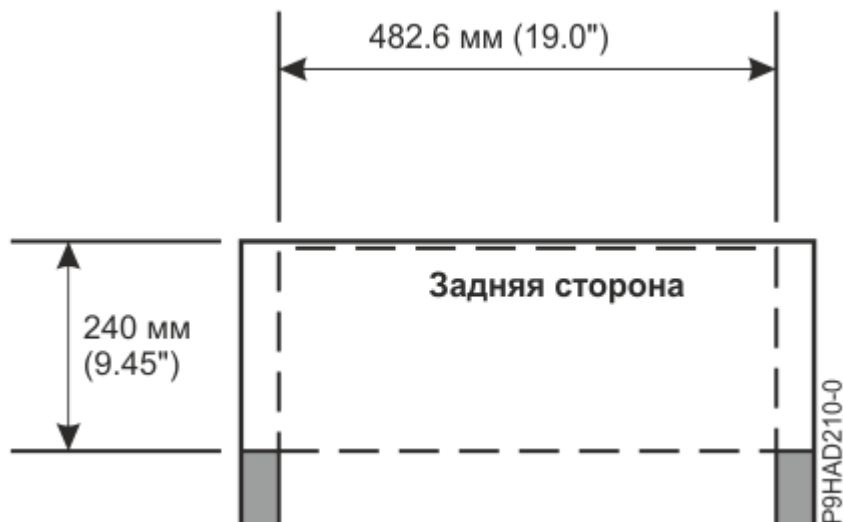
Рисунок 32. Зазор сзади для стойки моделей 9008-22L, 9009-22A, 9009-41A, 9009-42A, 9223-22H и 9223-42H
