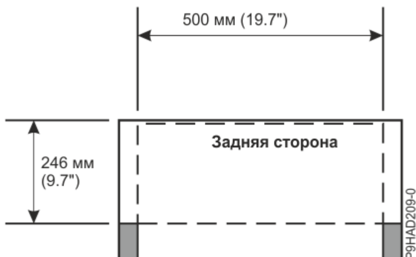
Рисунок 33. Зазор сзади для стойки моделей 9040-MR9
