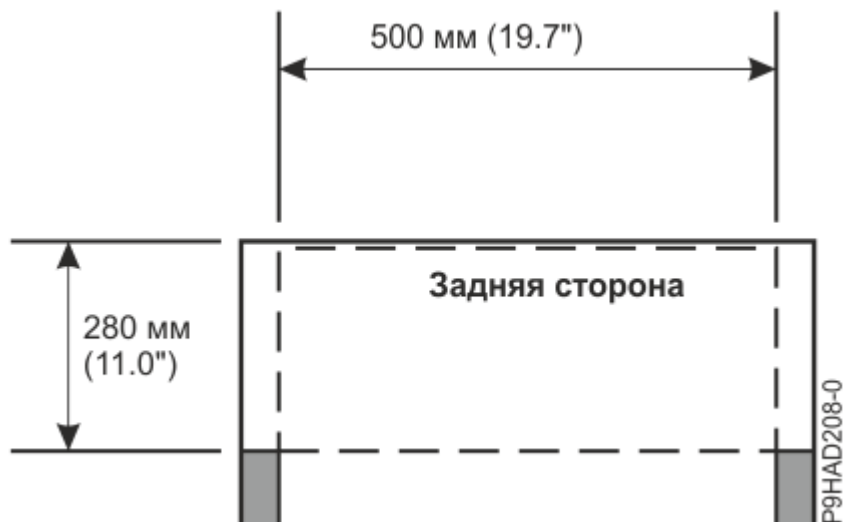
Рисунок 34. Зазор сзади для стойки моделей 9040-MR9
