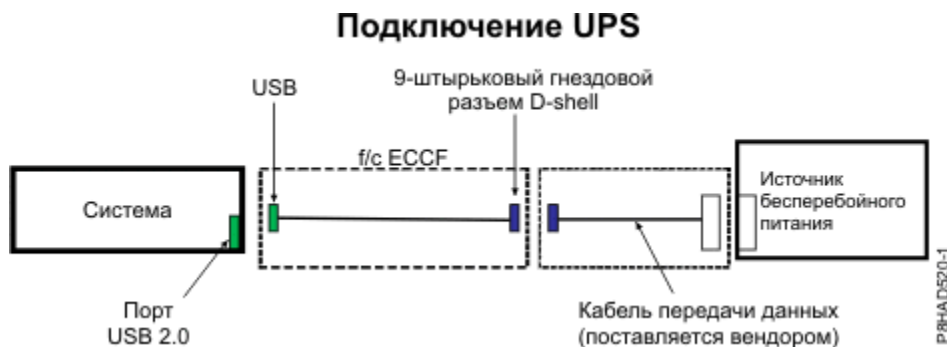
Рисунок 38. Подключение UPS
