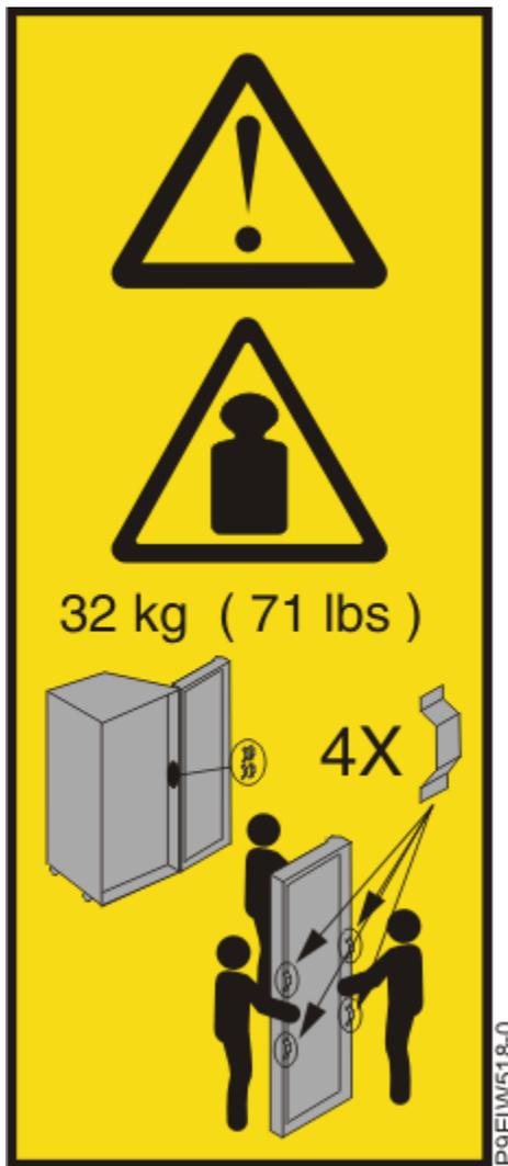
Figura 99. Peso do permutador de calor e pegas de elevação
