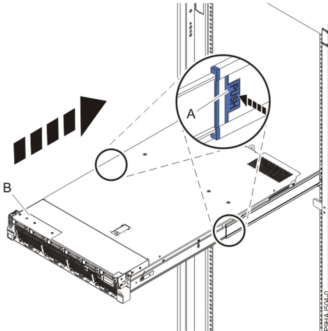
*Figura 77. Colocar o sistema na posição de funcionamento*
