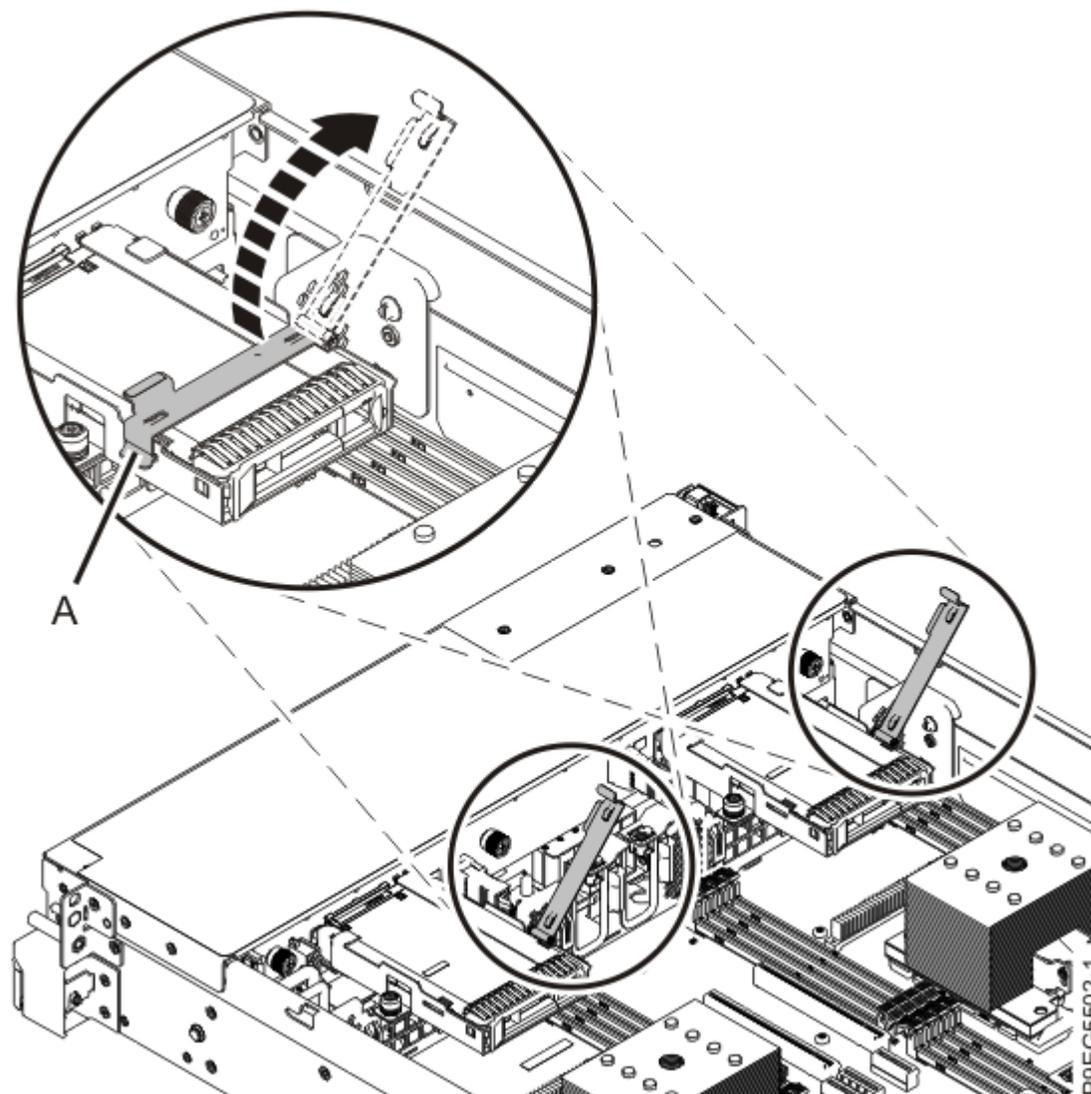
*Figura 27. Abrir a alavanca do suporte da unidade*
