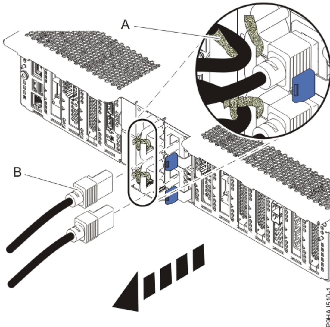
Figura 81. Remover os cabos de alimentação
