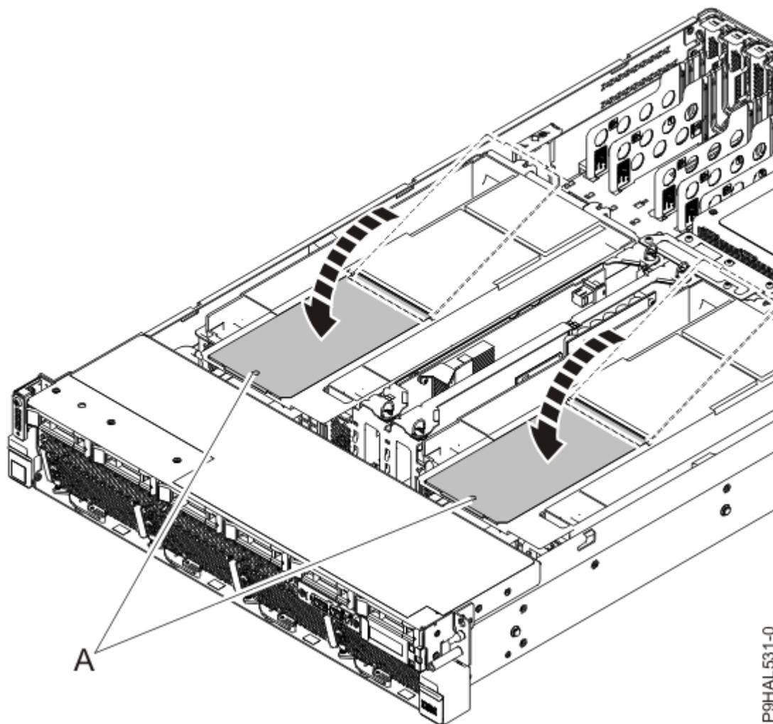
Figura 75. Fechar as portas de acesso com dobradiça na conduta de ventilação do sistema 9008-22L, 9009-22A ou 9223-22H
