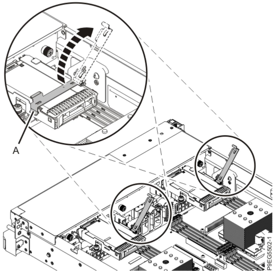
*Figura 11. Abrir a alavanca do suporte da unidade*
