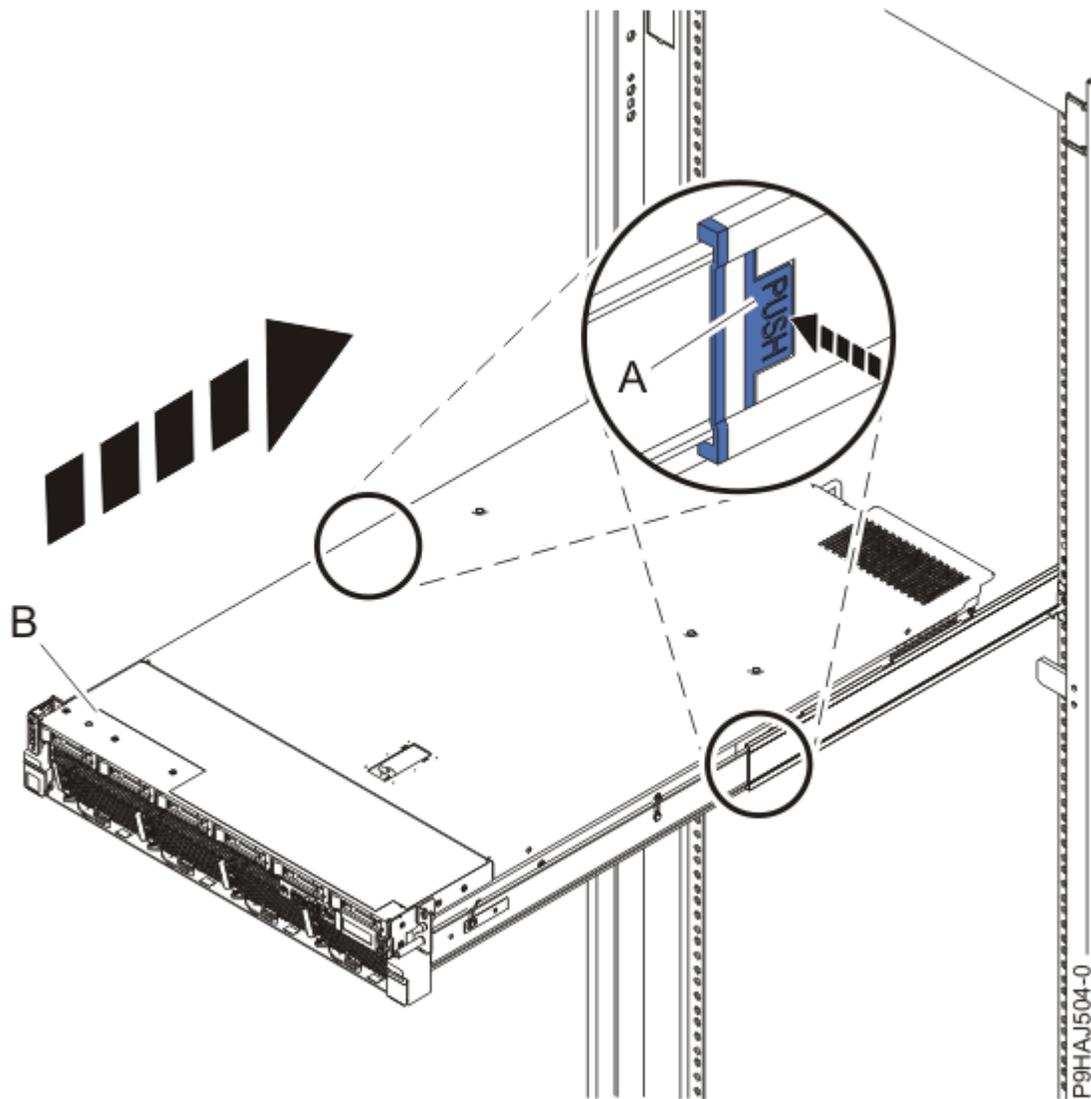
*Figura 34. Colocar o sistema na posição de funcionamento*
