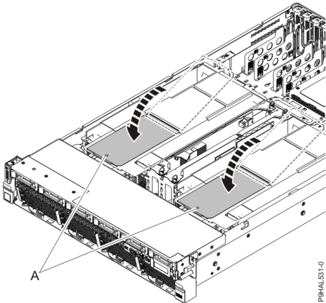
*Figura 91. Fechar as portas de acesso com dobradiça na conduta de ventilação do sistema 9008-22L, 9009-22A ou 9223-22H*
