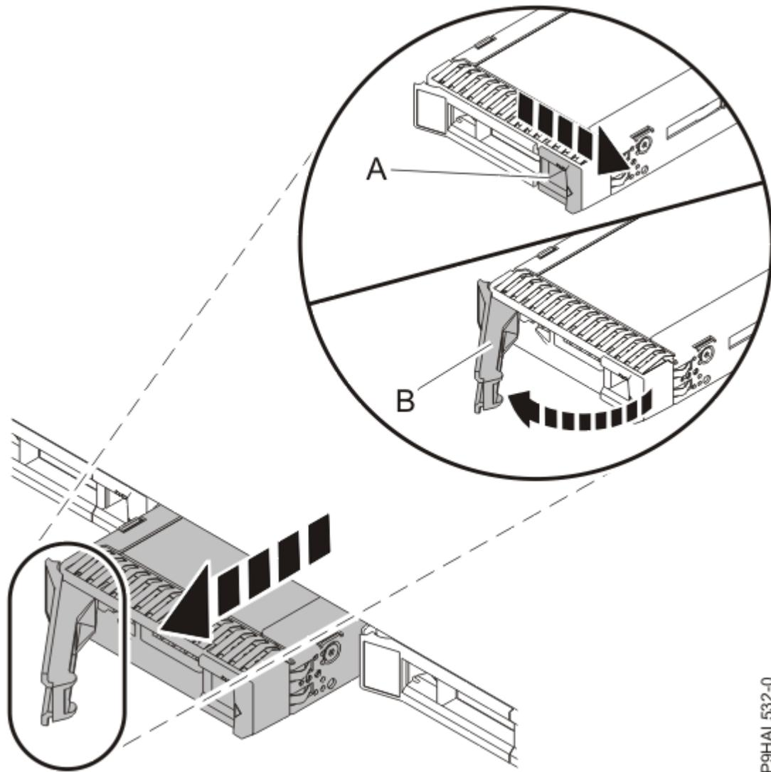
Figura 52. Desbloquear e remover a unidade
