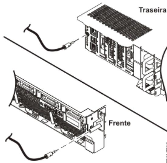
Figura 41. Localização dos conectores ESD num sistema 9008-22L, 9009-22A ou 9223-22H
