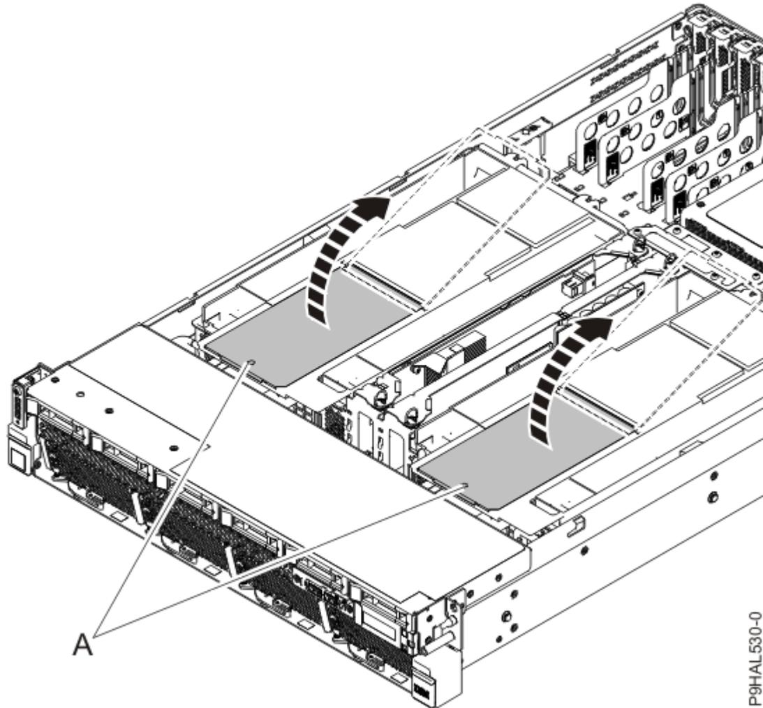
Figura 8. Abrir as portas de acesso com dobradiça na conduta de ventilação do sistema 9008-22L, 9009-22A ou 9223-22H
