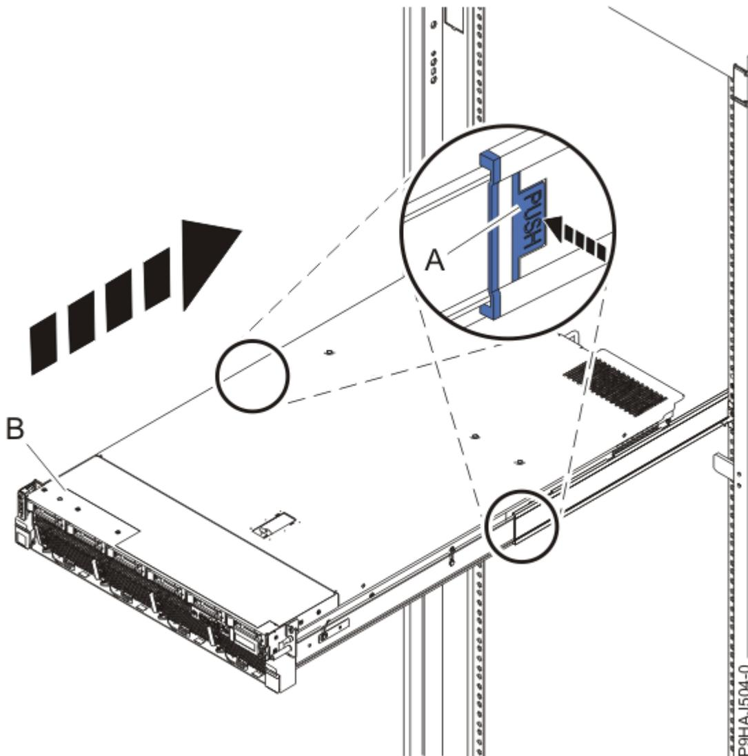
*Figura 93. Colocar o sistema na posição de funcionamento*
