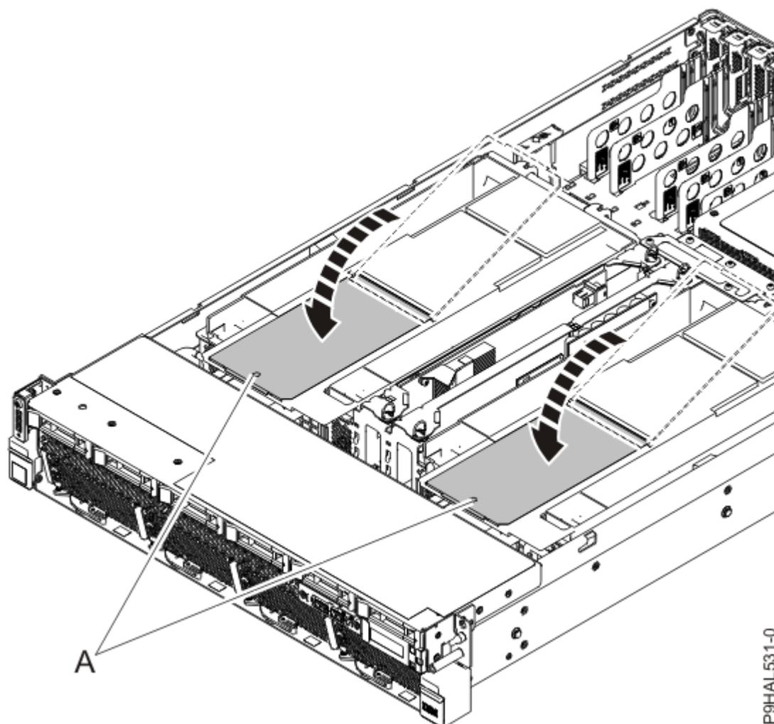
*Figura 32. Fechar as portas de acesso com dobradiça na conduta de ventilação do sistema 9008-22L, 9009-22A ou 9223-22H*
