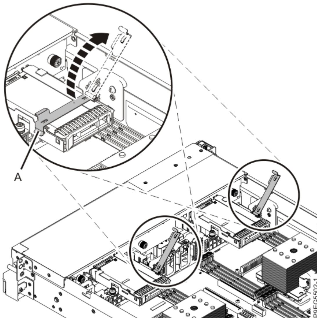
*Figura 85. Abrir a alavanca do suporte da unidade*
