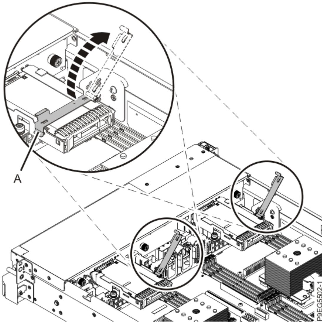
Figura 49. Abrir a alavanca do suporte da unidade
