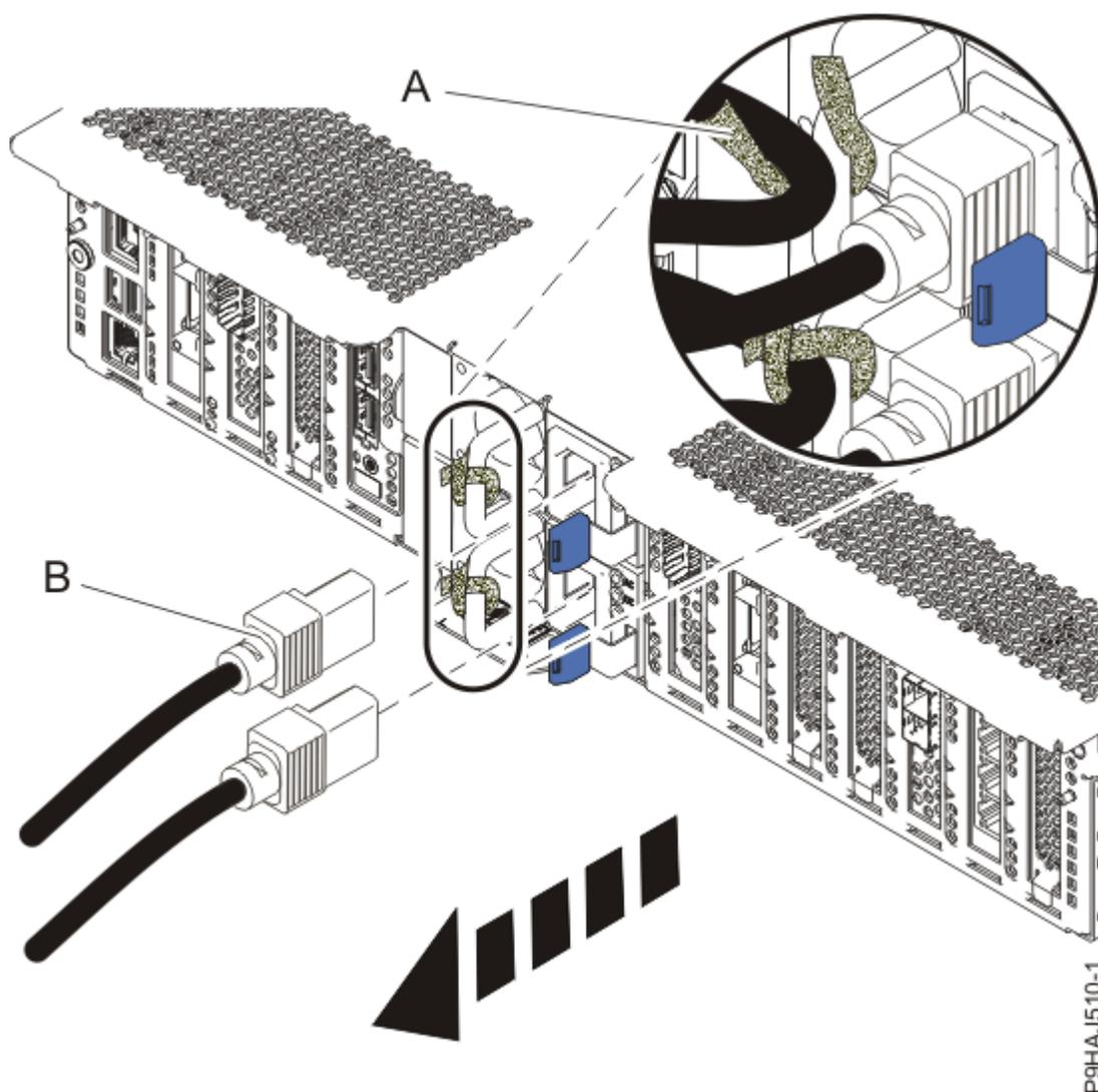
*Figura 38. Remover os cabos de alimentação*
