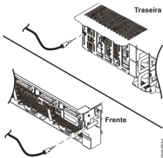
Figura 9. Localização dos conectores ESD num sistema 9008-22L, 9009-22A ou 9223-22H
