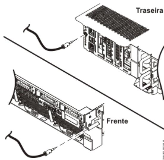
Figura 6. Localização dos conectores ESD num sistema 9008-22L, 9009-22A ou 9223-22H
