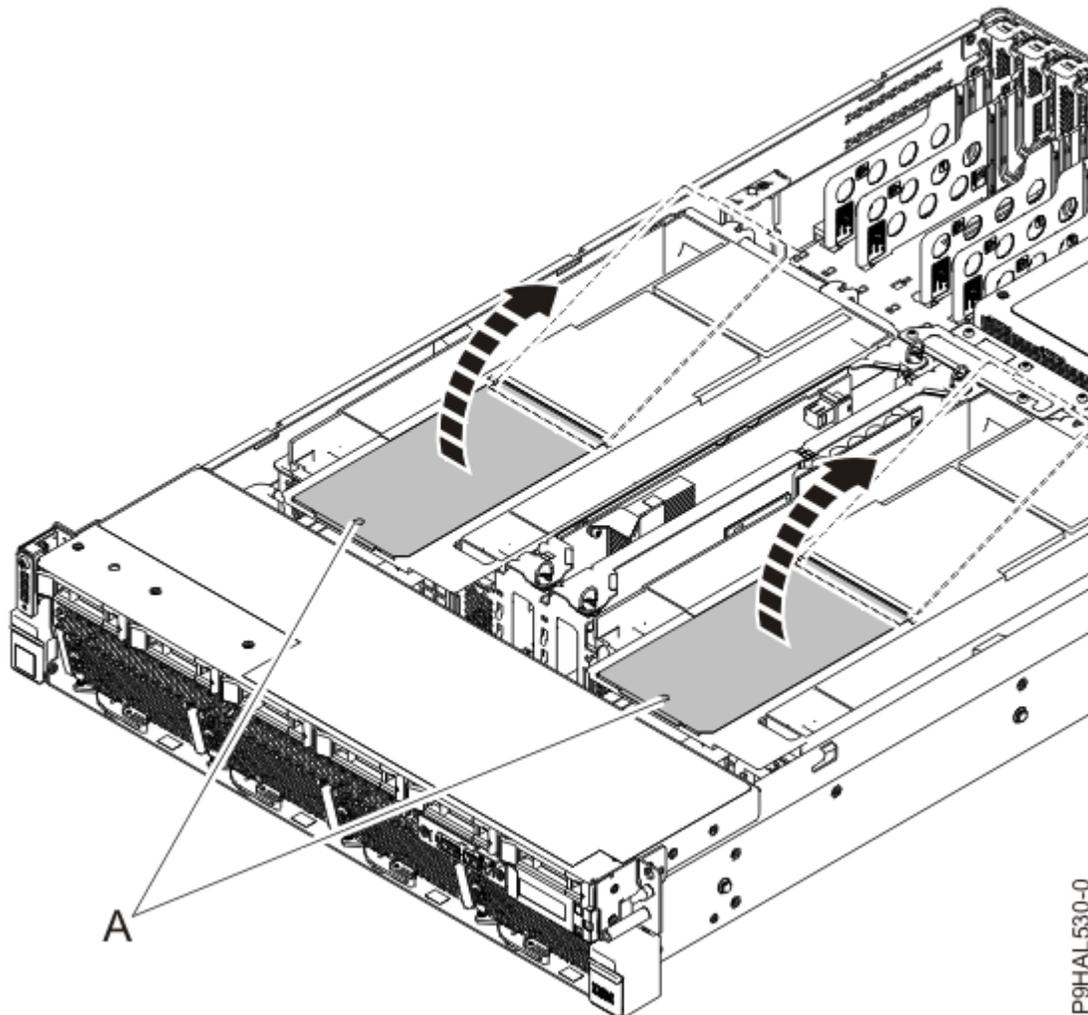
Figura 84. Abrir as portas de acesso com dobradiça na conduta de ventilação do sistema 9008-22L, 9009-22A ou 9223-22H
