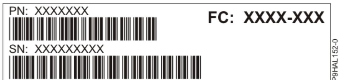
Figura 12. Exemplo de uma etiqueta do sistema ou unidade de expansão
