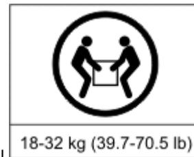
O peso deste componente ou unidade situa-se entre 18 e 32 kg (39,7 e 70,5 lb). São necessárias duas pessoas para levantar com segurança este componente ou unidade. (C009)
