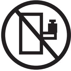
**Perigo:** Dispositivos montados em bastidor não devem ser utilizados como prateleiras ou espaços de trabalho. Não coloque objectos sobre os dispositivos montados em bastidor. Adicionalmente, não se apoie em dispositivos montados em bastidores e não os utilize para estabilizar a sua posição corporal (por exemplo, quando trabalha numa escada). (L002)
