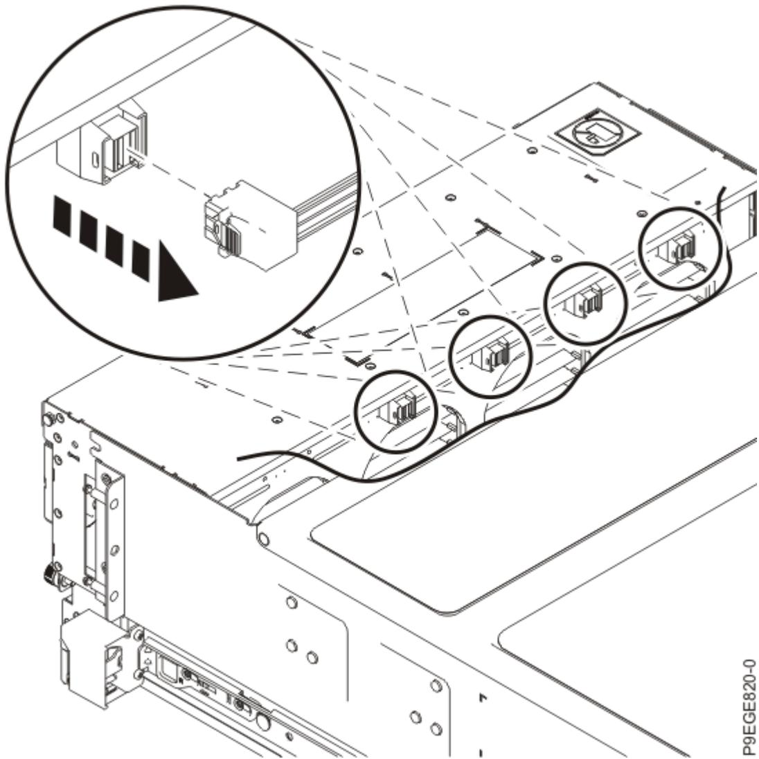
*Figura 7. Desconectando os cabos SAS do painel traseiro da unidade de disco expandida*
