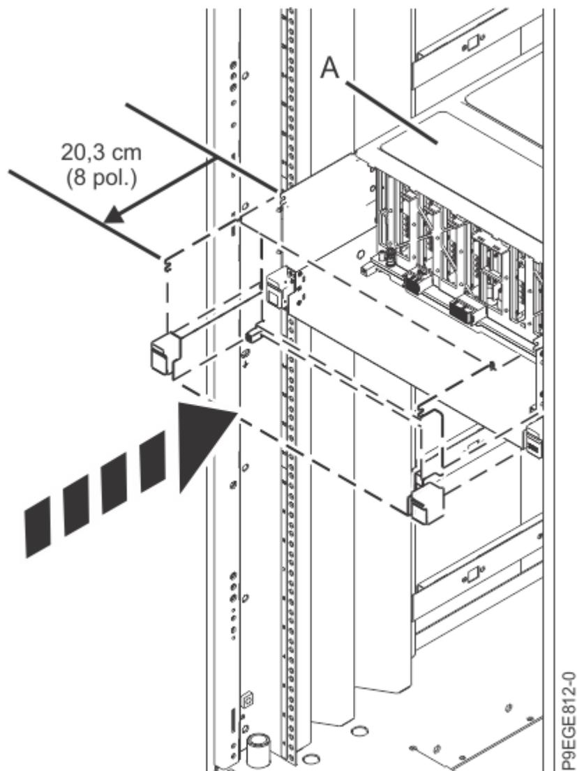
*Figura 12. Deslizando parcialmente o sistema para dentro do rack*
