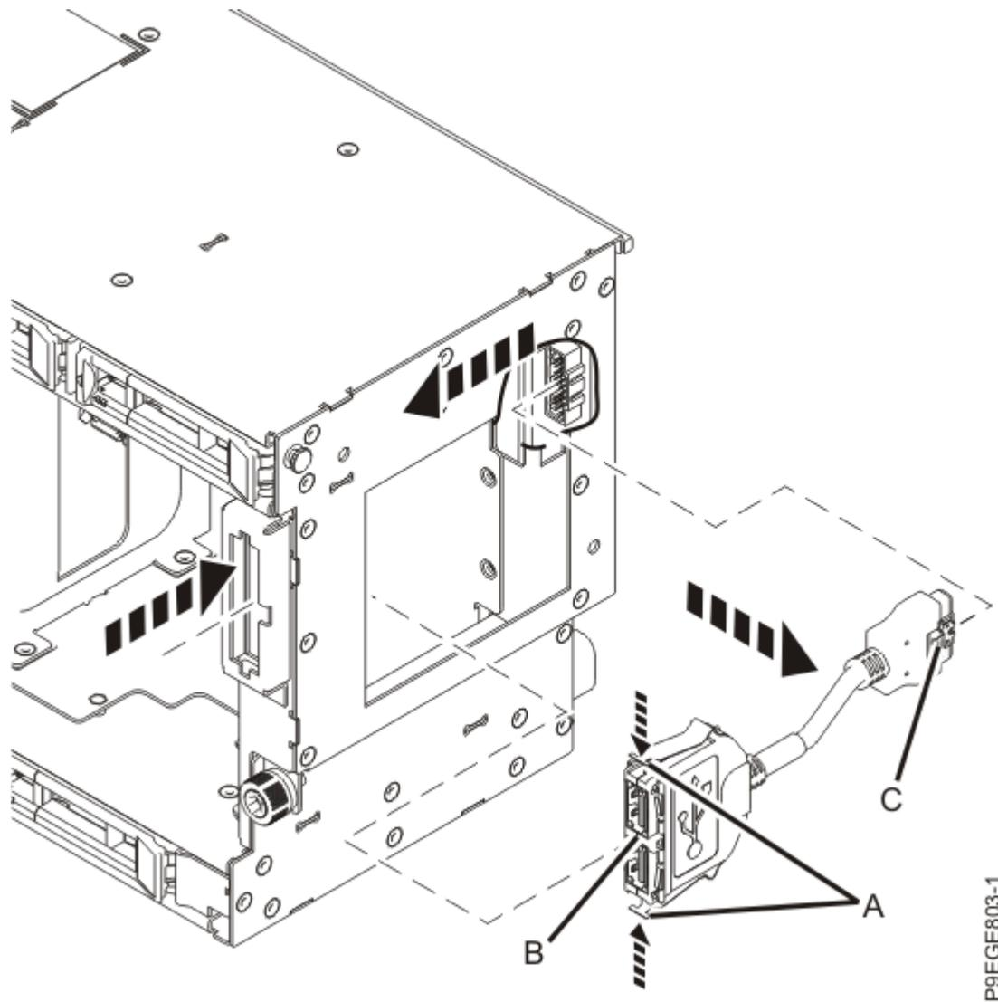
Figura 9. Removendo o conector da porta USB frontal
