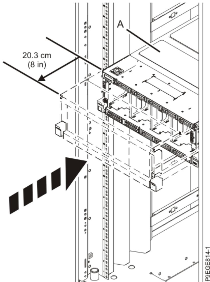
Figura 16. Colocando o Sistema na Posição de Operação
