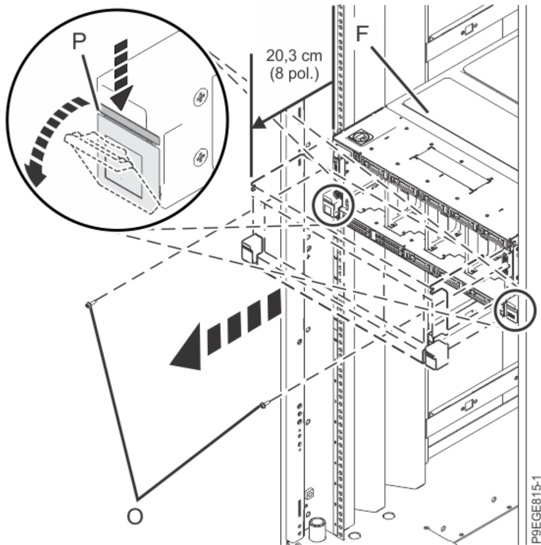
Figura 5. Deslizando parcialmente o sistema do rack
