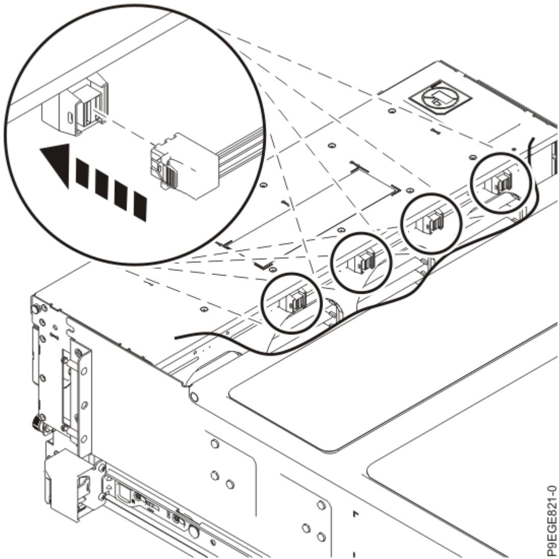
Figura 14. Conectando os cabos SAS ao painel traseiro da unidade de disco de função expandida
