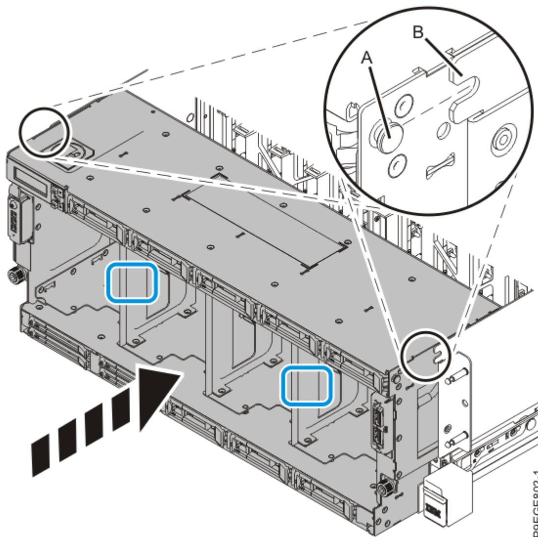
Figura 11. Substituindo parcialmente o painel traseiro da unidade de disco
