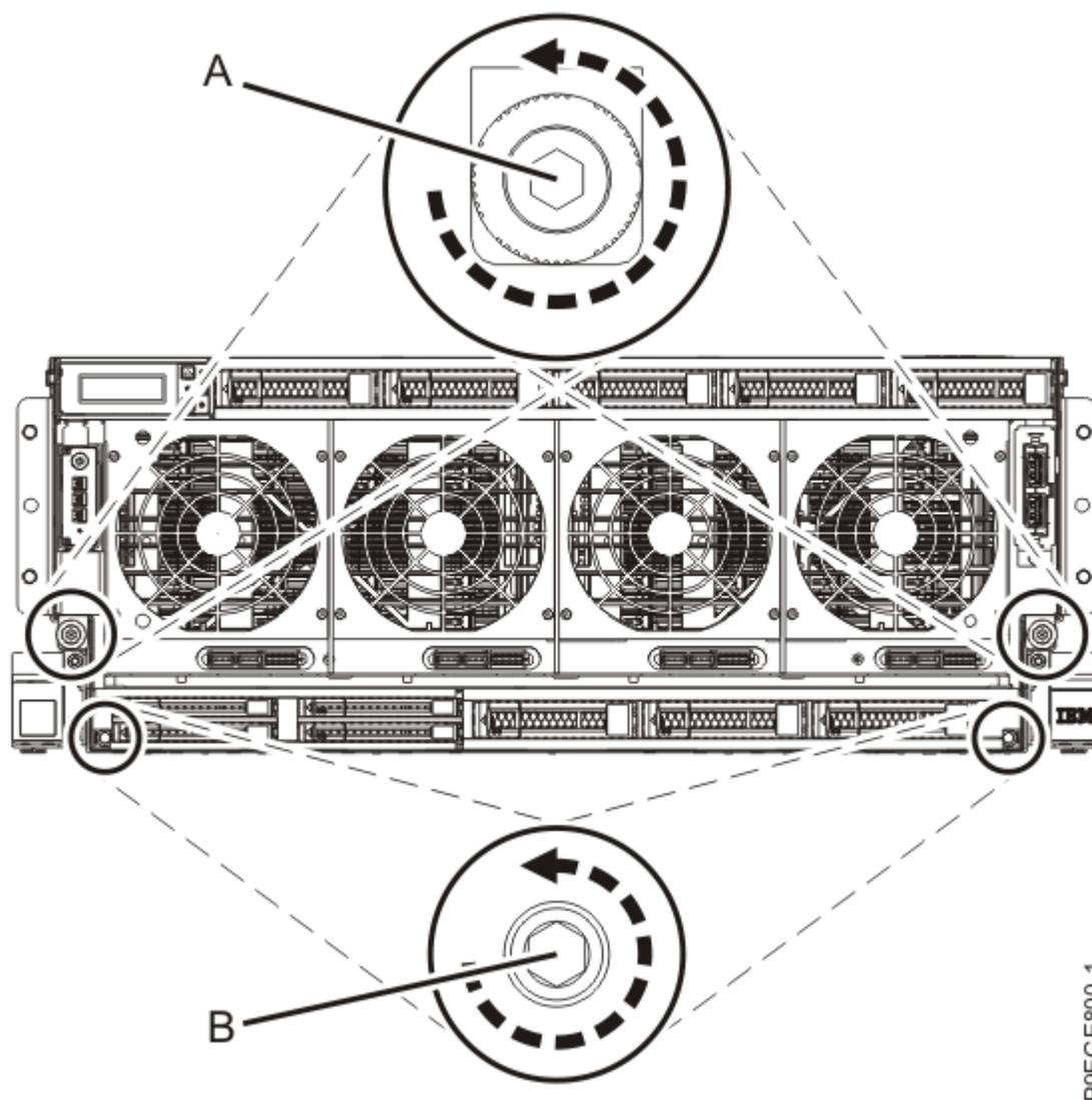
*Figura 3. Soltando os parafusos do painel traseiro da unidade de disco*
