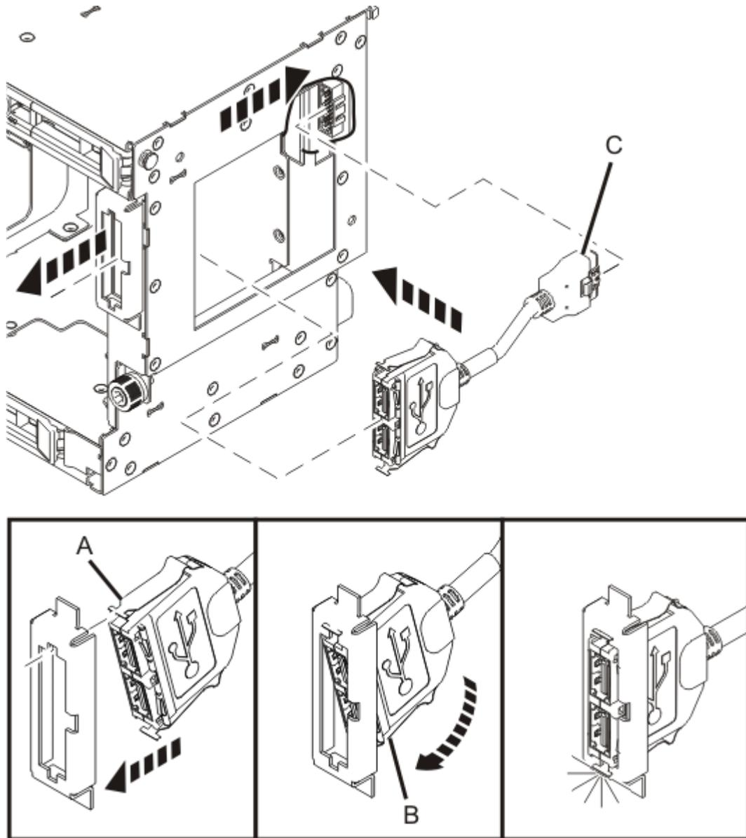
Figura 10. Substituindo o conector da porta USB frontal
