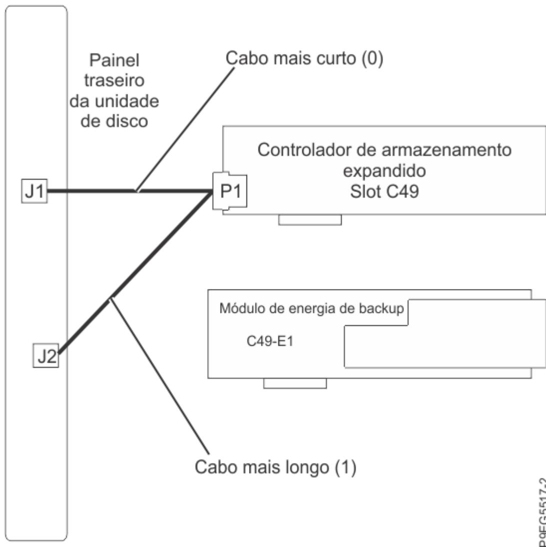
Figura 11. Reconectando o cabo SAS em "Y" em uma configuração de controlador de armazenamento de alto desempenho
