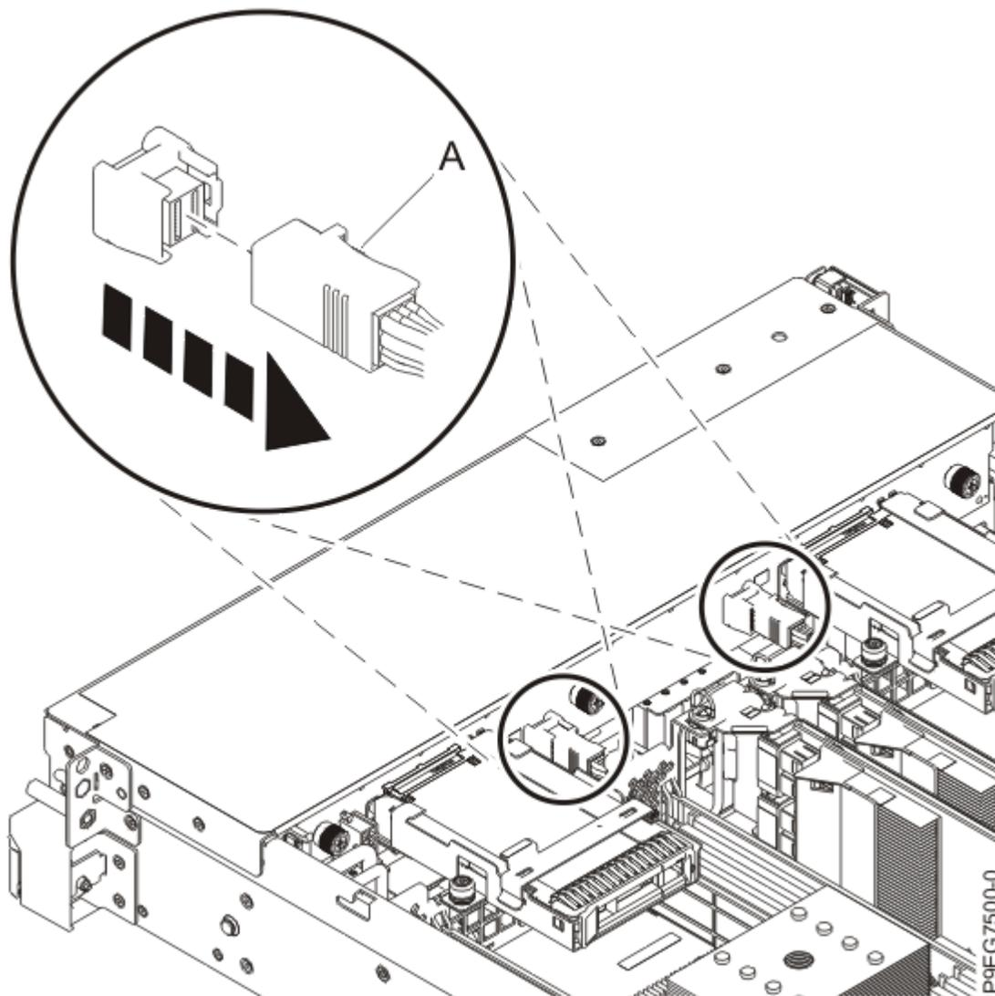
*Figura 6. Desconectando os cabos SAS frontais*
