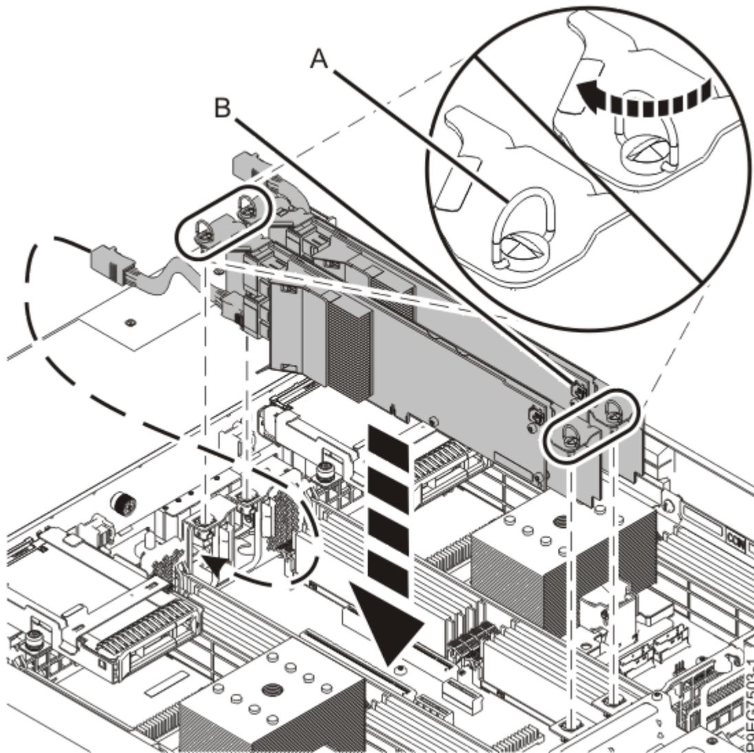
Figura 12. Substituindo o adaptador SAS RAID
