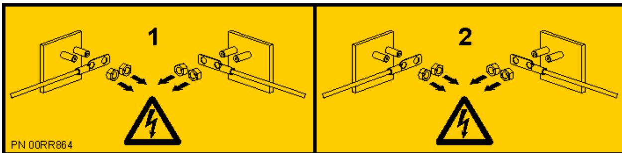
**PERIGO:** Vários cabos de alimentação. O produto deve estar equipado com vários cabos de energia de corrente alternada ou vários cabos de energia de corrente contínua. Para remover todas as voltagens perigosas, desconecte todos os cabos de energia. (L003)
