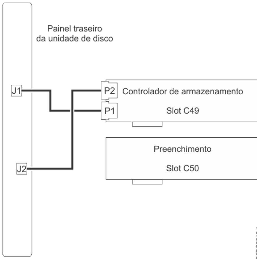
Figura 9. Reconectando o cabo SAS em uma configuração de armazenamento de base
