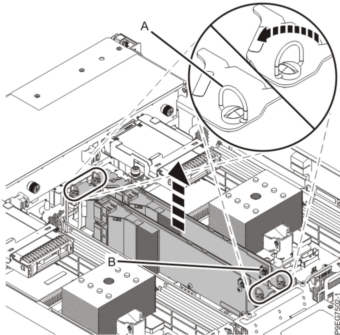
Figura 7. Removendo o adaptador SAS RAID
