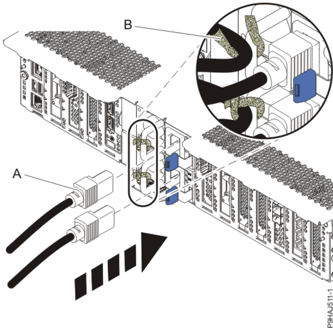
Figura 15. Conectando os Cabos de Alimentação
