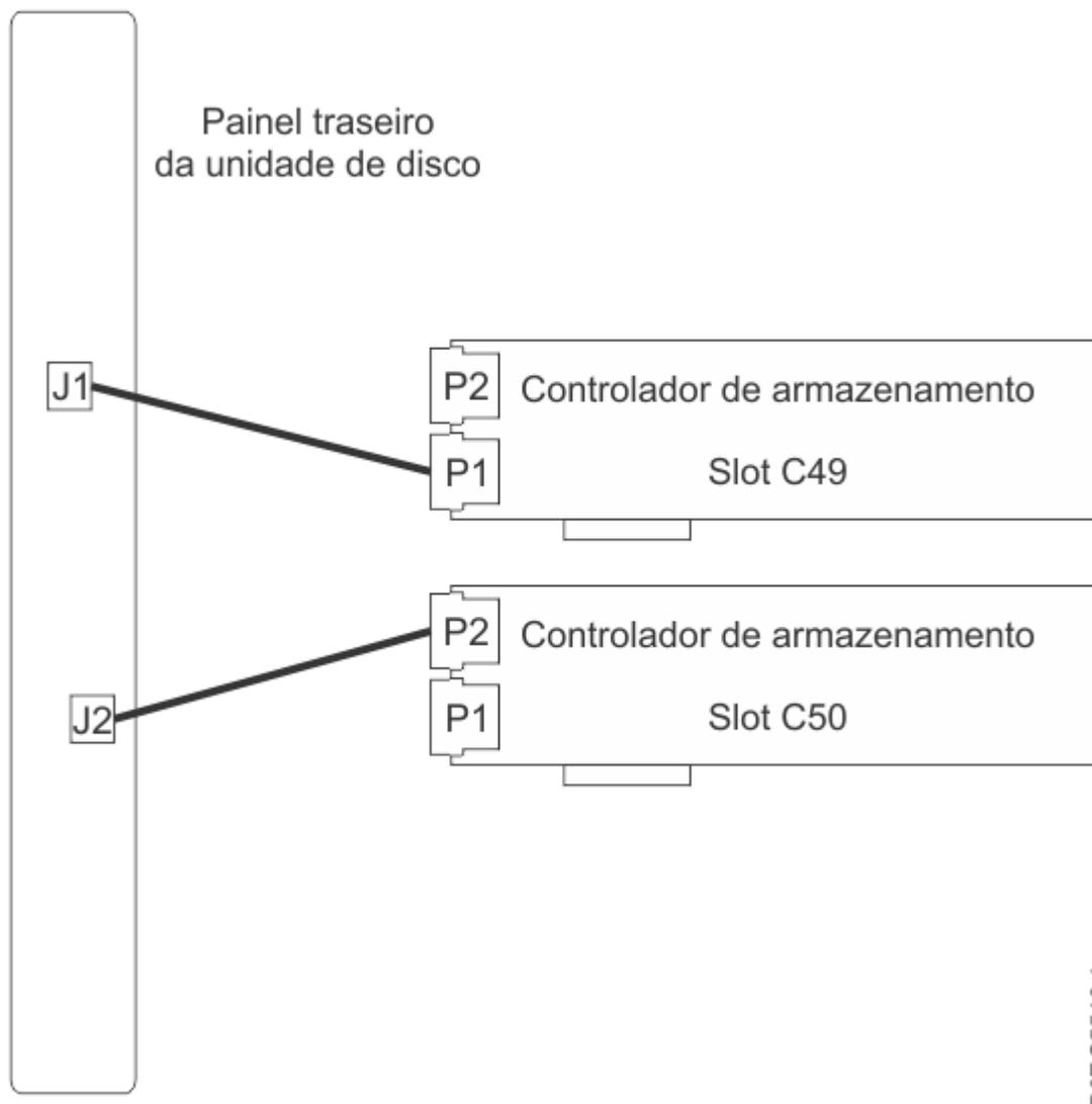
Figura 10. Reconectando o cabo SAS em uma configuração de divisão de disco
