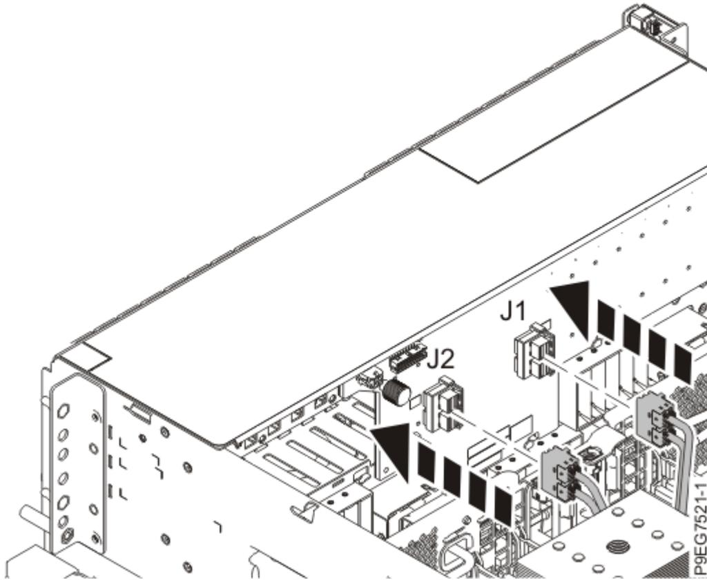
Figura 11. Reconnectando os cabos SAS frontais para o painel traseiro da unidade de disco função base
