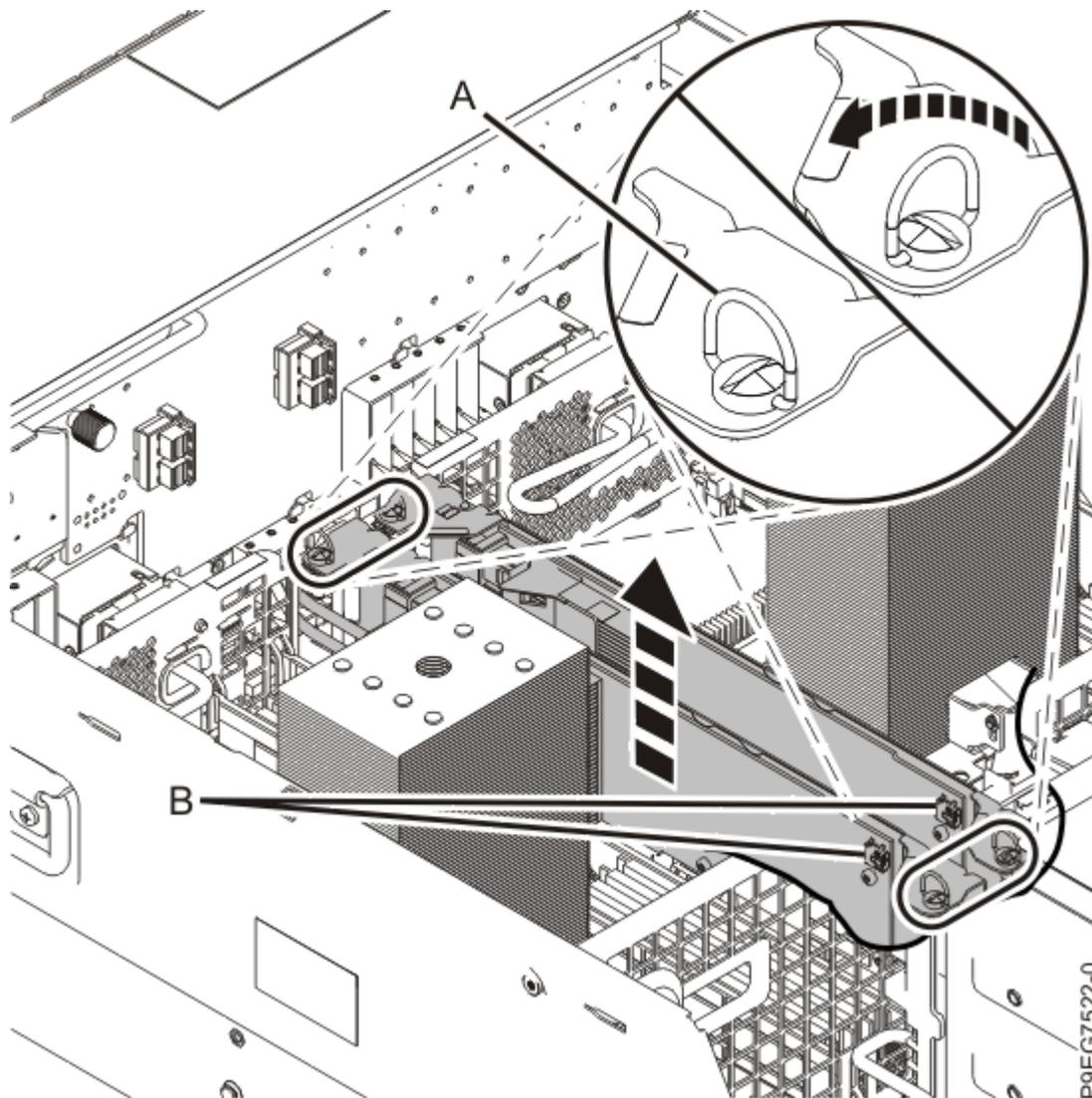
Figura 10. Removendo o adaptador SAS RAID
