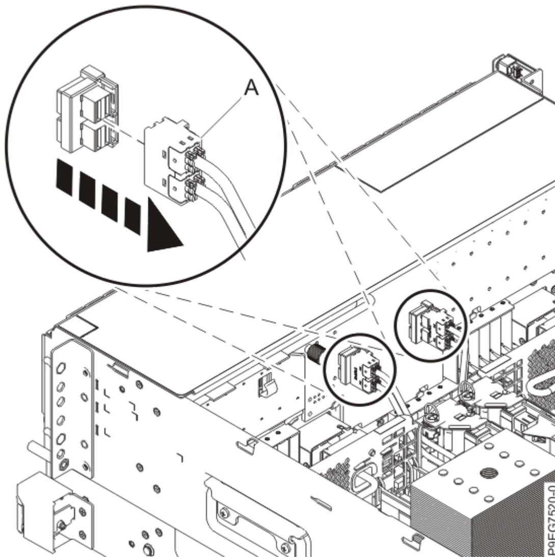
Figura 9. Desconectando os cabos SAS frontais
