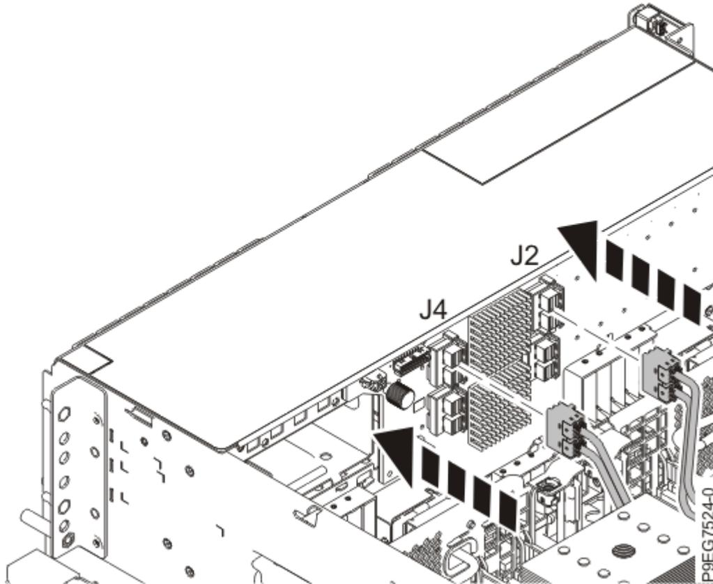
Figura 12. Reconectando os cabos SAS frontais para o painel traseiro da unidade de disco função expandida de 12 unidades ou função expandida de 18 unidades
