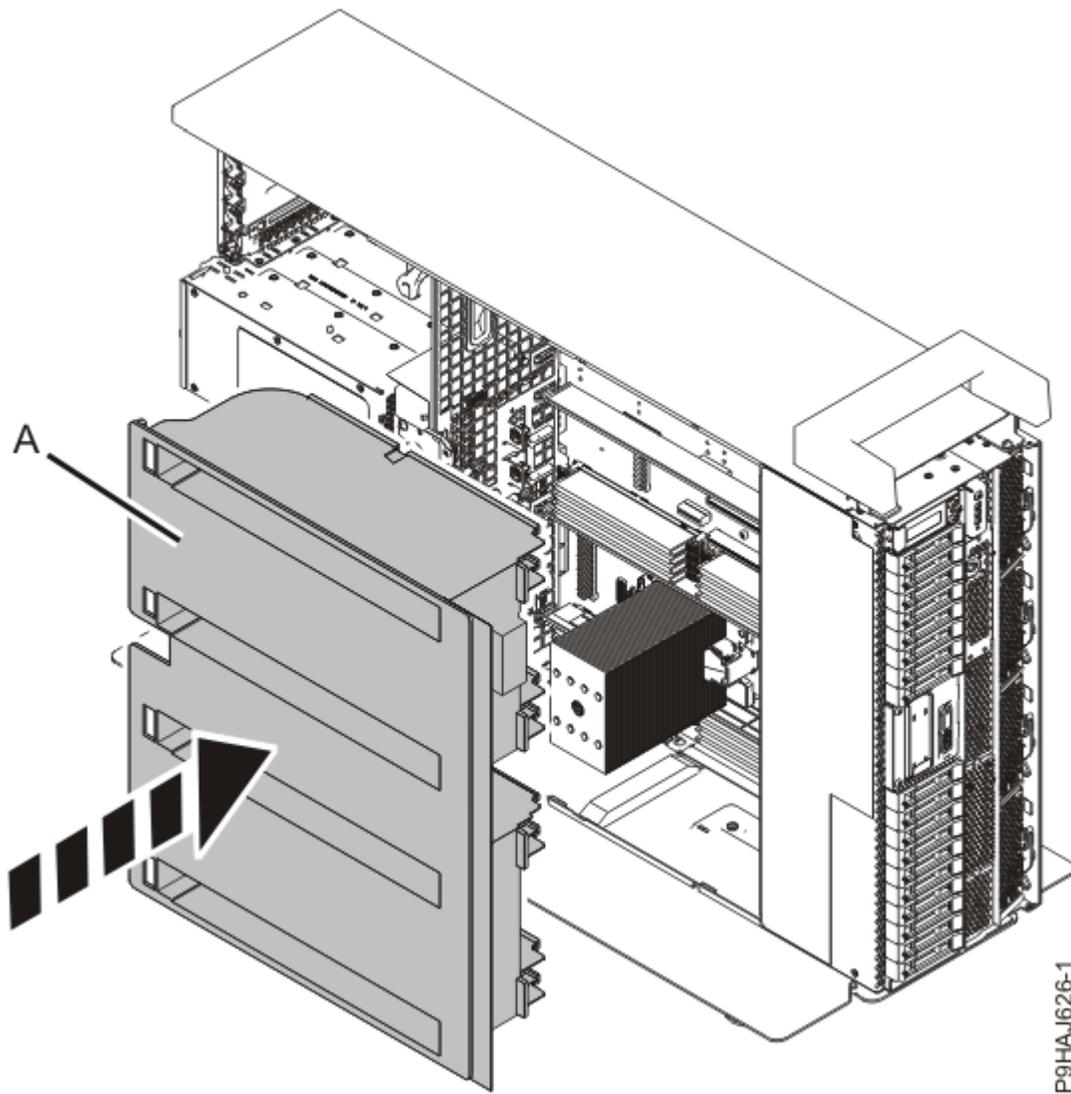
Figura 19. Substituindo a placa defletora de ar em um sistema independente
