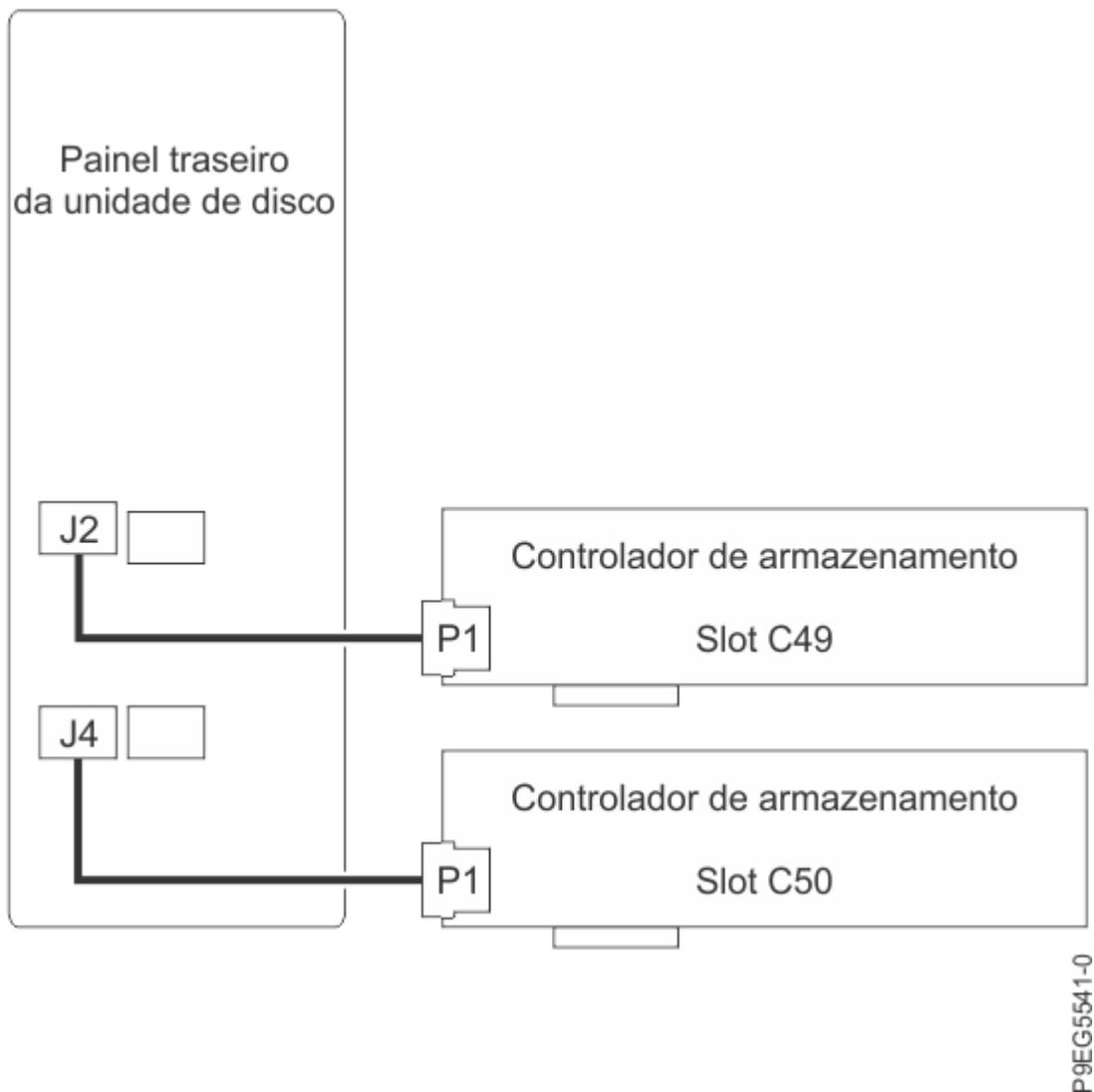
Figura 15. Reconnectando o cabo SAS na configuração de função expandida de 12 unidades
