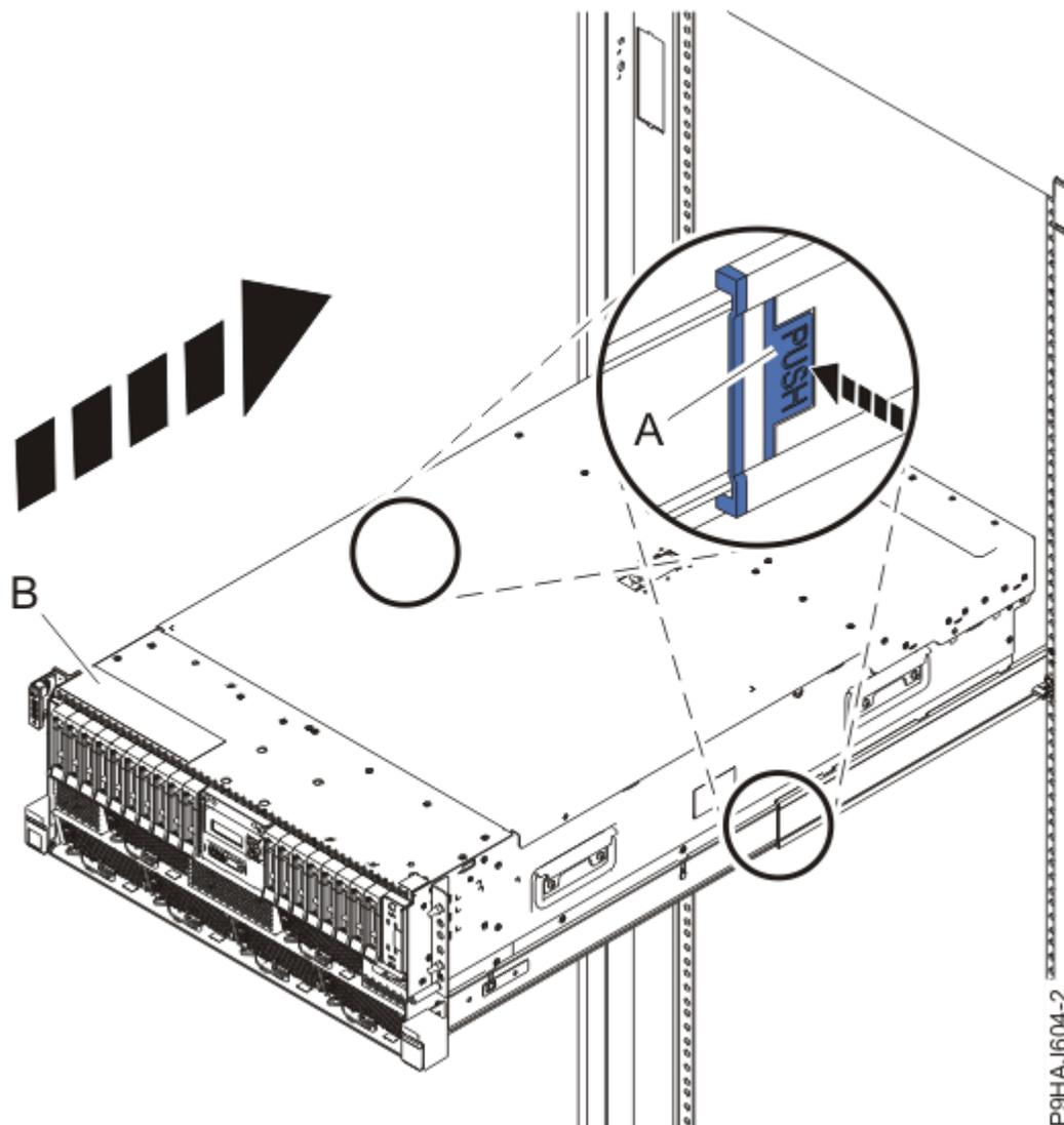
*Figura 22. Colocando o Sistema na Posição de Operação*
