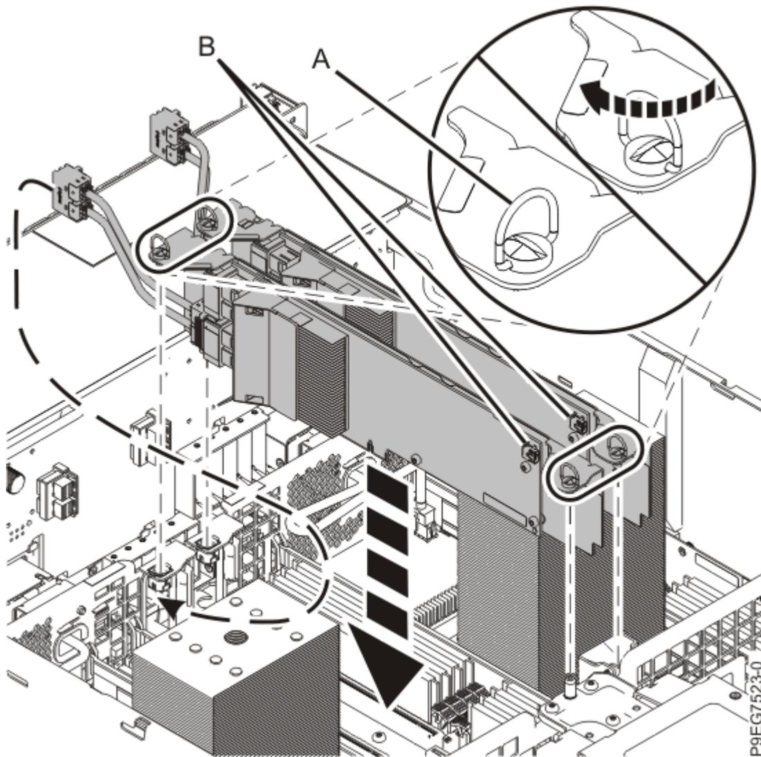
Figura 17. Substituindo o adaptador SAS RAID
