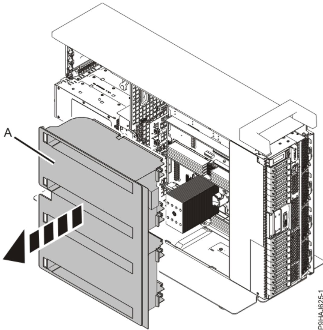
*Figura 8. Removendo a placa defletora de ar de um sistema independente*
