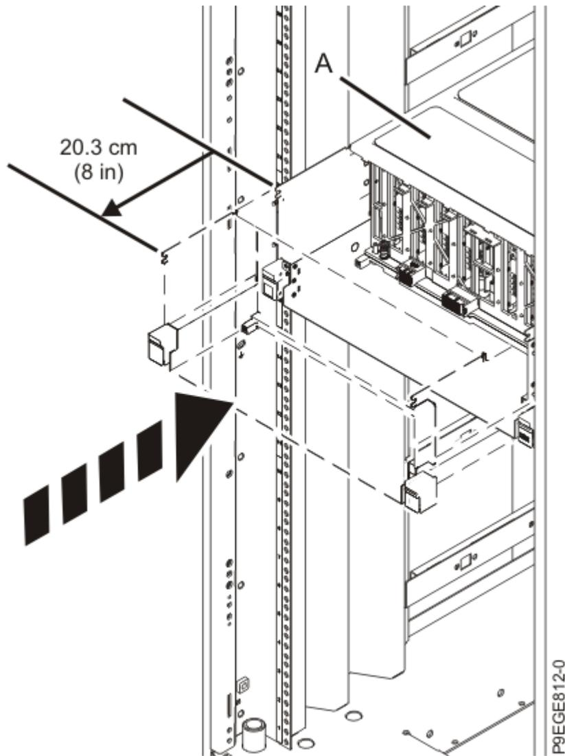
*Figura 20. Deslizando parcialmente o sistema para dentro do rack*
