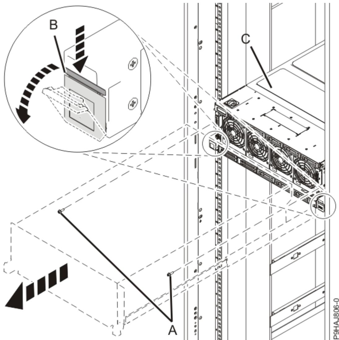
Figura 3. Colocando o sistema na posição de serviço
