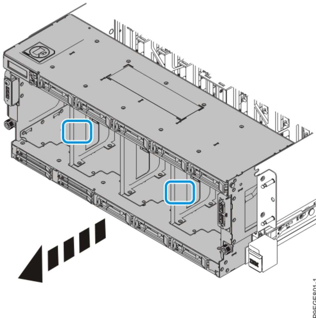
Figura 12. Removendo Parcialmente o Painel Traseiro da Unidade de Disco
