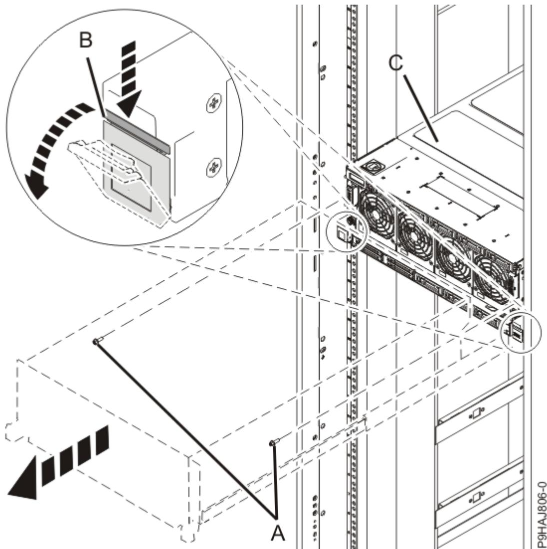
Figura 31. Colocando o sistema na posição de serviço
