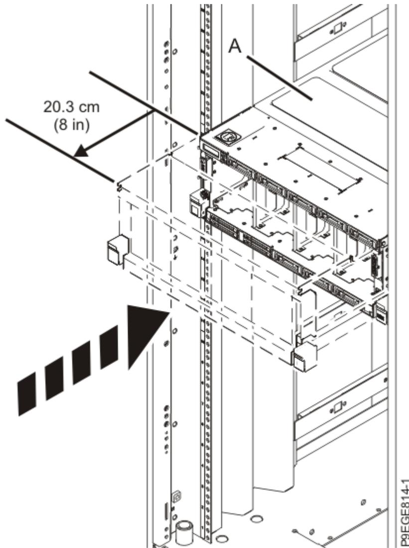
Figura 24. Colocando o Sistema na Posição de Operação
