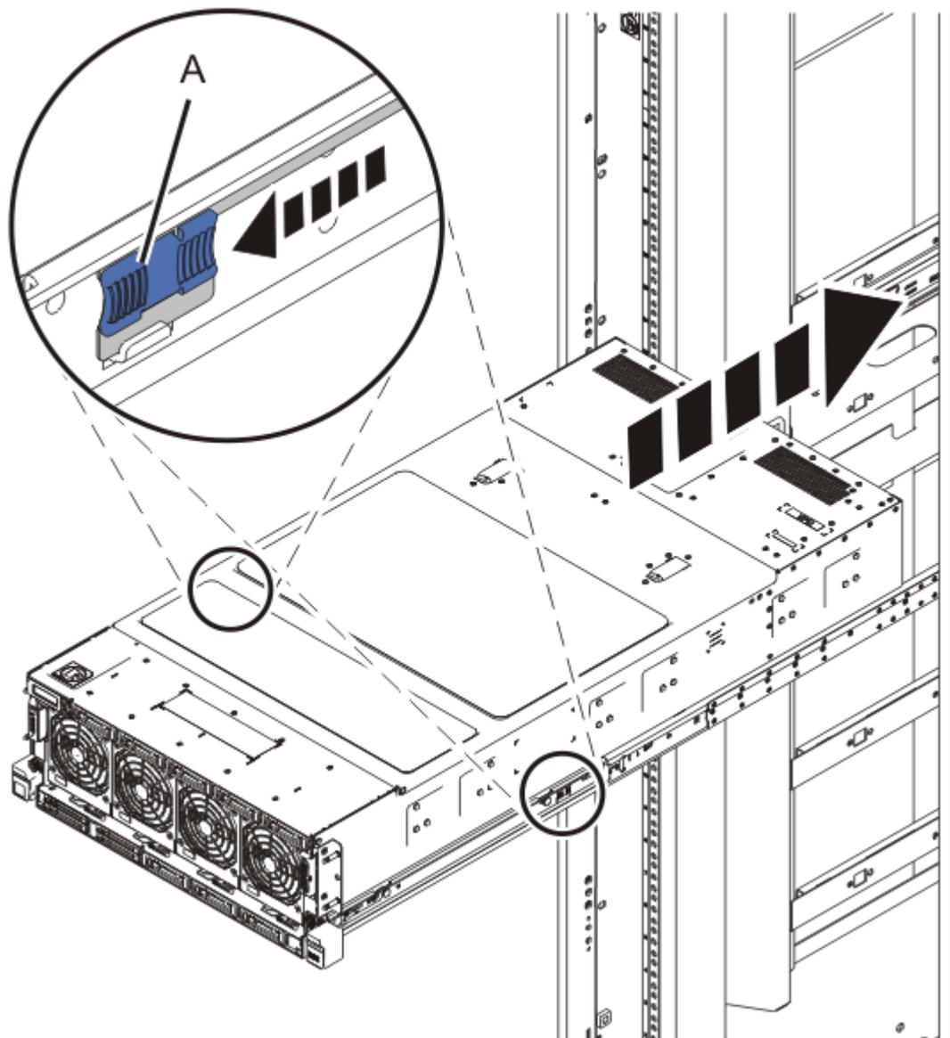
*Figura 33. Colocando o Sistema na Posição de Operação*
