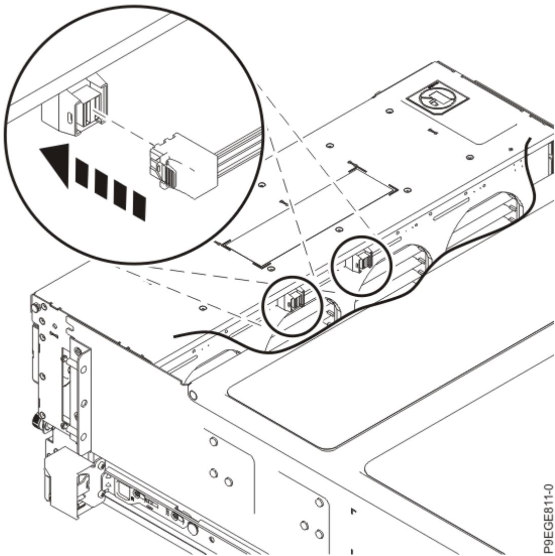
Figura 21. Conectando os cabos SAS ao painel traseiro da unidade de disco de função base
