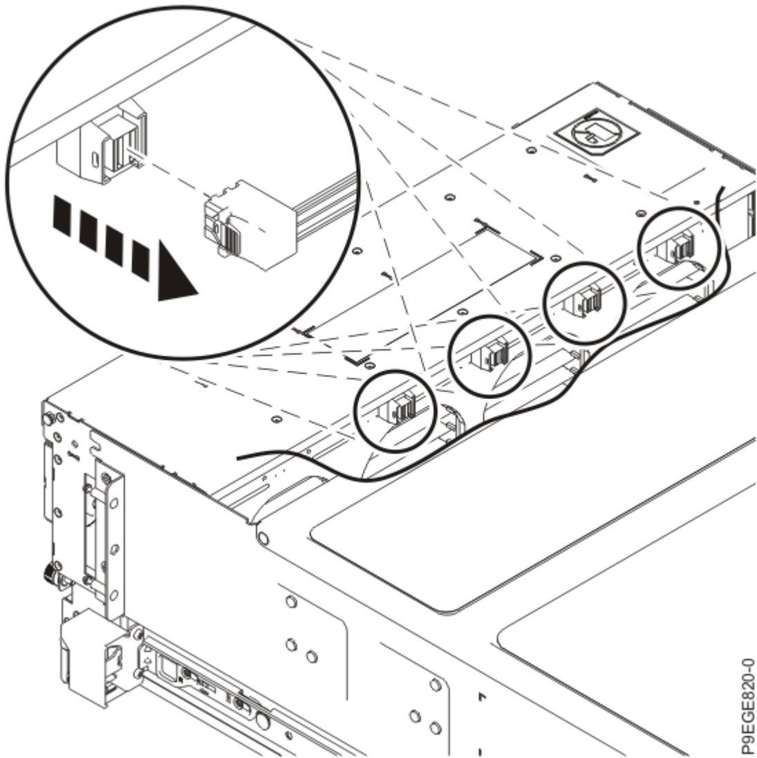
*Figura 15. Desconectando os cabos SAS do painel traseiro da unidade de disco expandida*
