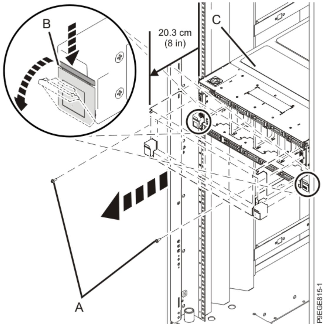
Figura 13. Deslizando parcialmente o sistema do rack
