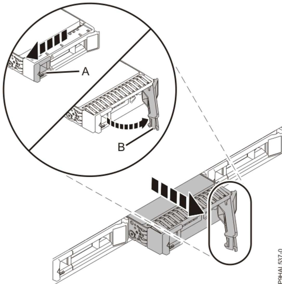
Figura 6. Destravando e removendo a unidade
