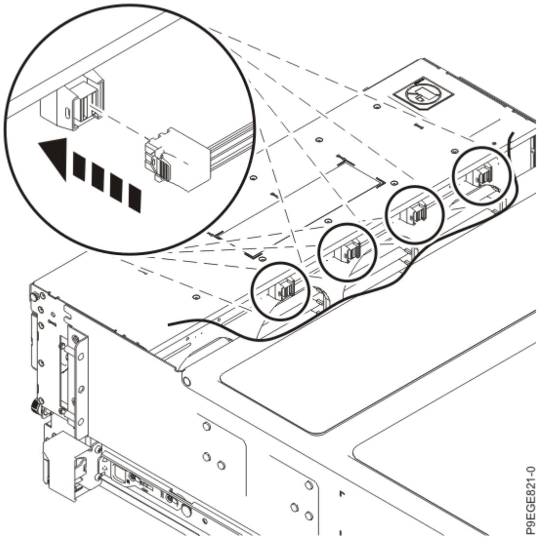
*Figura 22. Conectando os cabos SAS ao painel traseiro da unidade de disco de função expandida*
