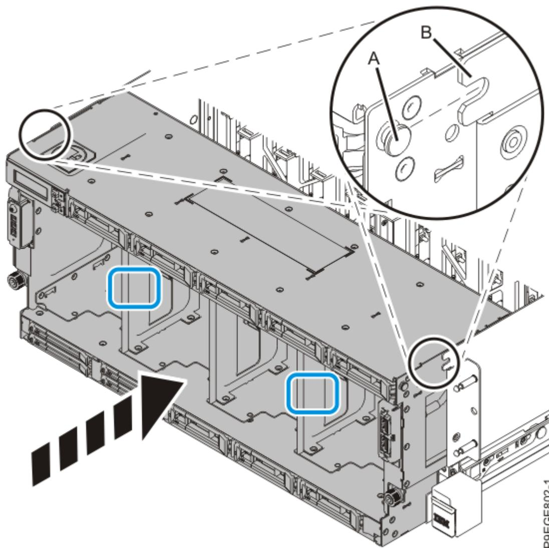
Figura 19. Substituindo parcialmente o painel traseiro da unidade de disco
