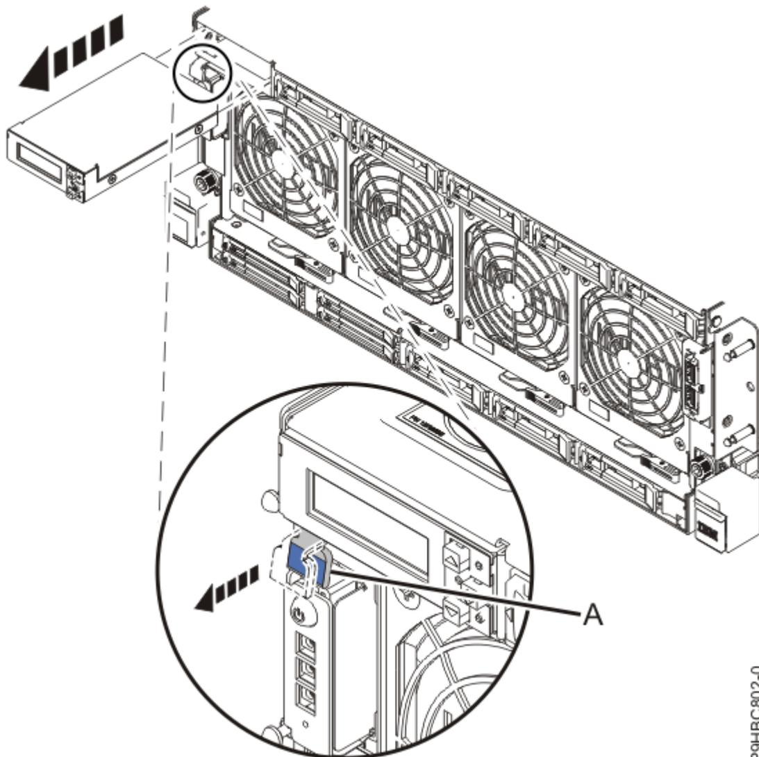
*Figura 9. Removendo a tela do painel de controle*
