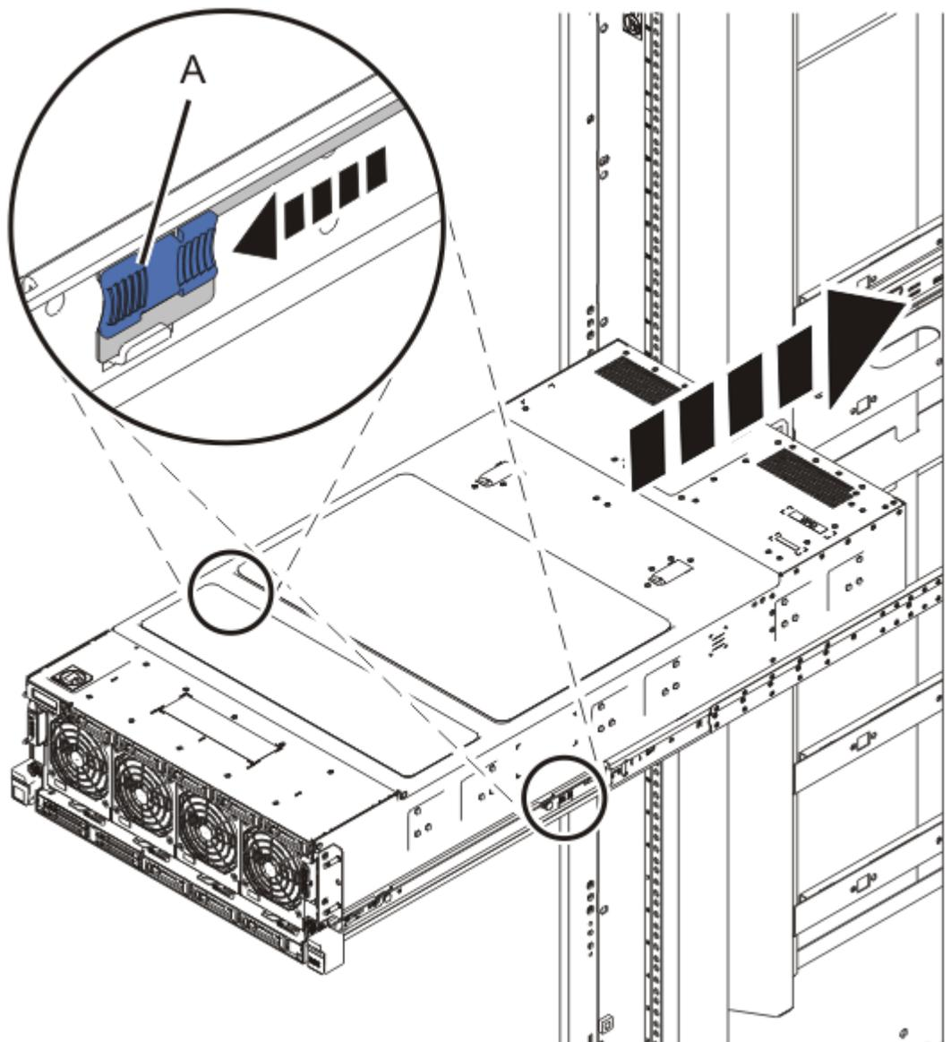
Figura 5. Colocando o Sistema na Posição de Operação
