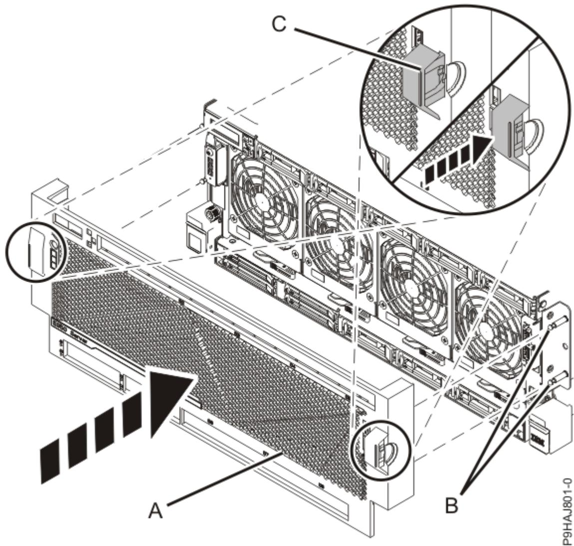
*Figura 34. Instalando a Tampa Frontal*
