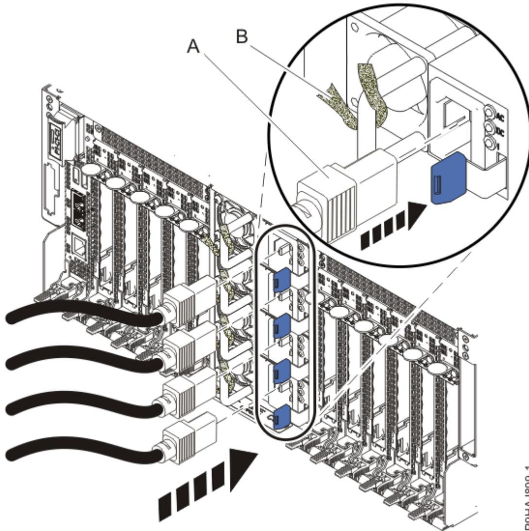
Figura 35. Conectando os Cabos de Energia
