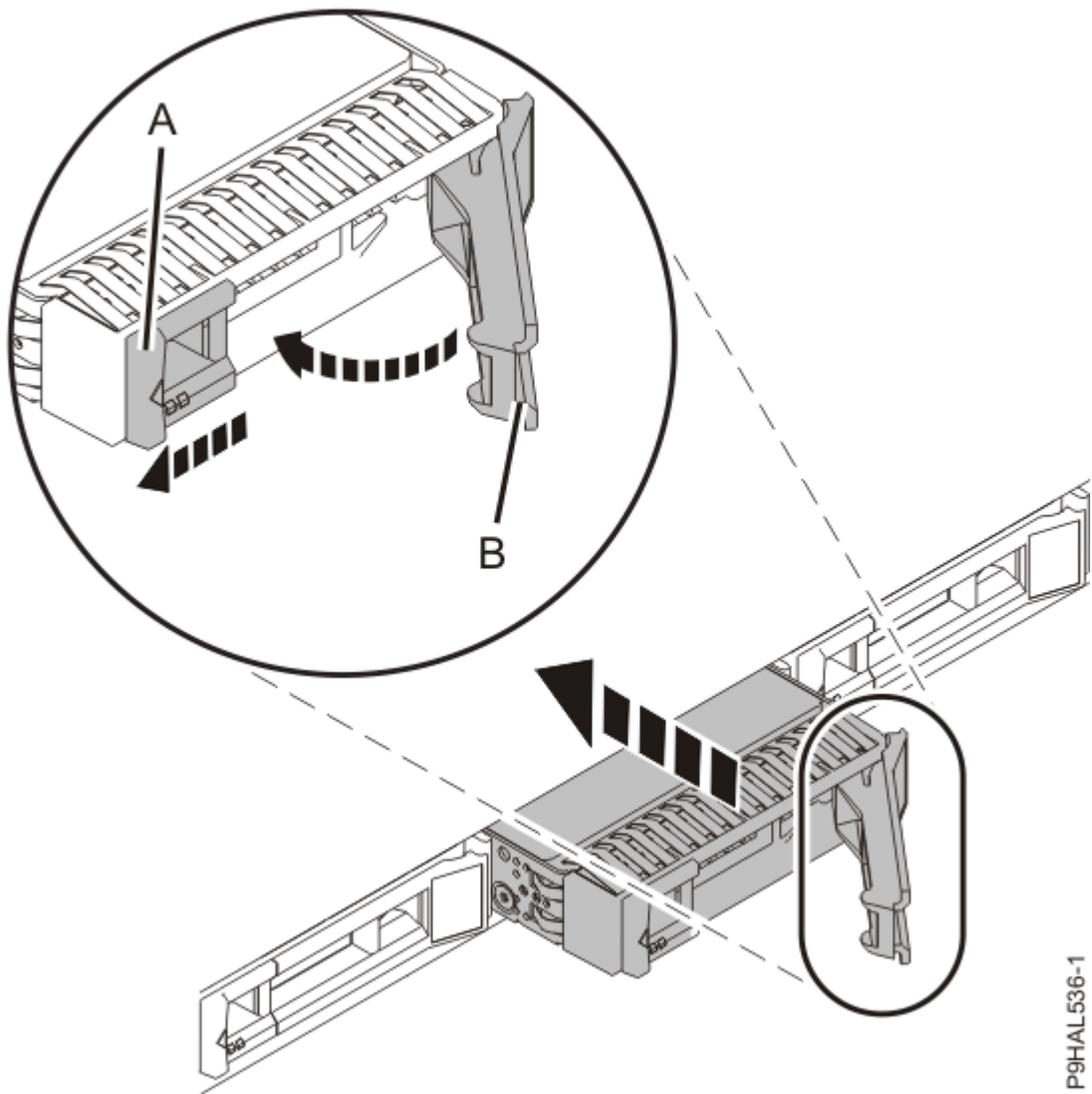
Figura 30. Instalando uma unidade em um sistema
