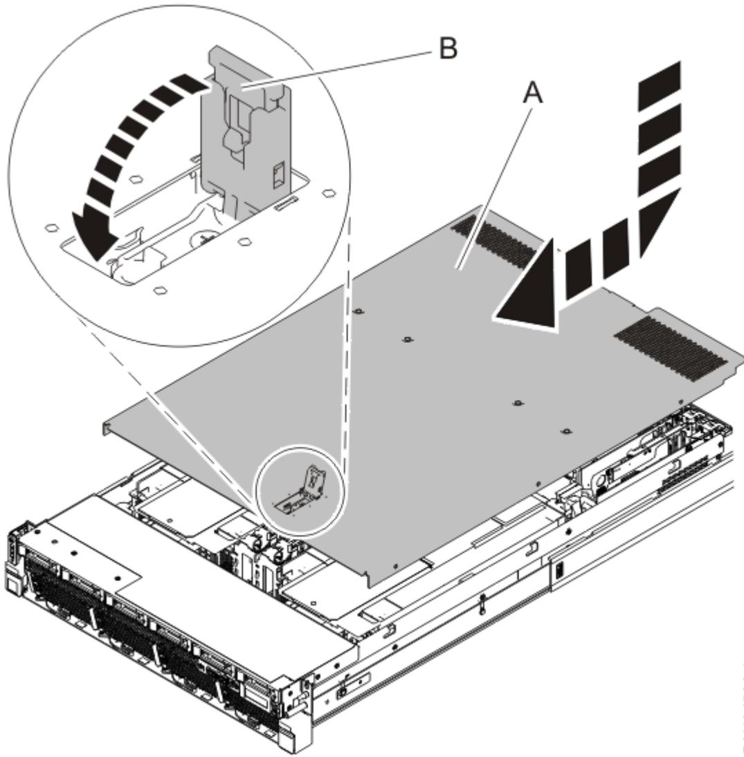
그림 8. 서비스 액세스 커버 설치
