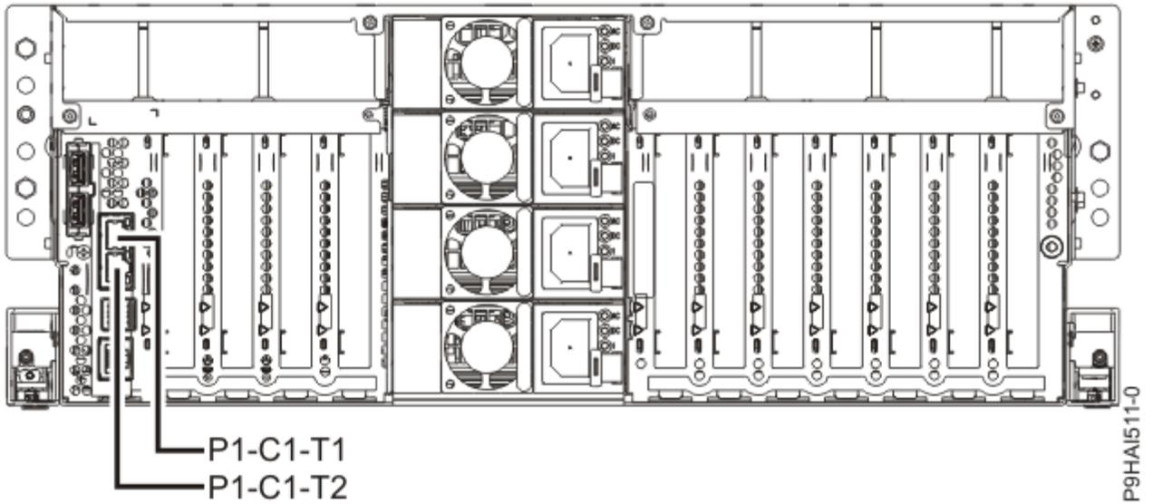
그림 7. 9009-41A, 9009-42A 및 9223-42H HMC 포트 위치
