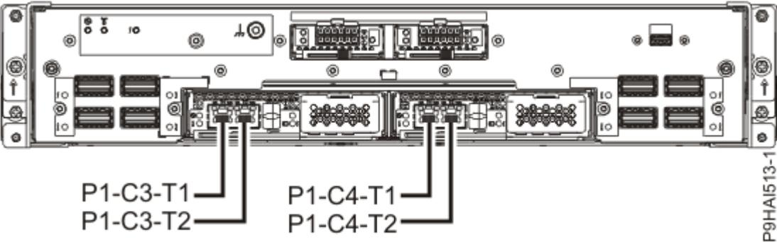
그림 9. 9080-M9S HMC 포트 위치
