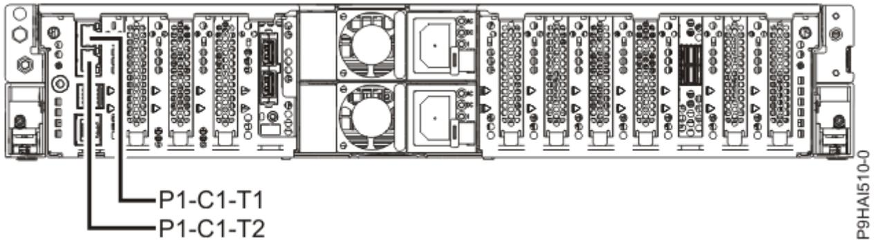
그림 6. 9008-22L, 9009-22A 및 9223-22H HMC 포트 위치
