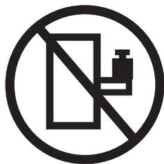
危険: ラック・マウント型デバイスを棚やワークスペースとして使用しないでください。ラックに搭載された装置の上にものを載せないでください。また、ラックに取り付けられた装置に寄り掛かかったり、(はしごに乗って作業している場合などに) 体の位置を安定させるためにそれらの装置を使用したりしないでください。(L002)
