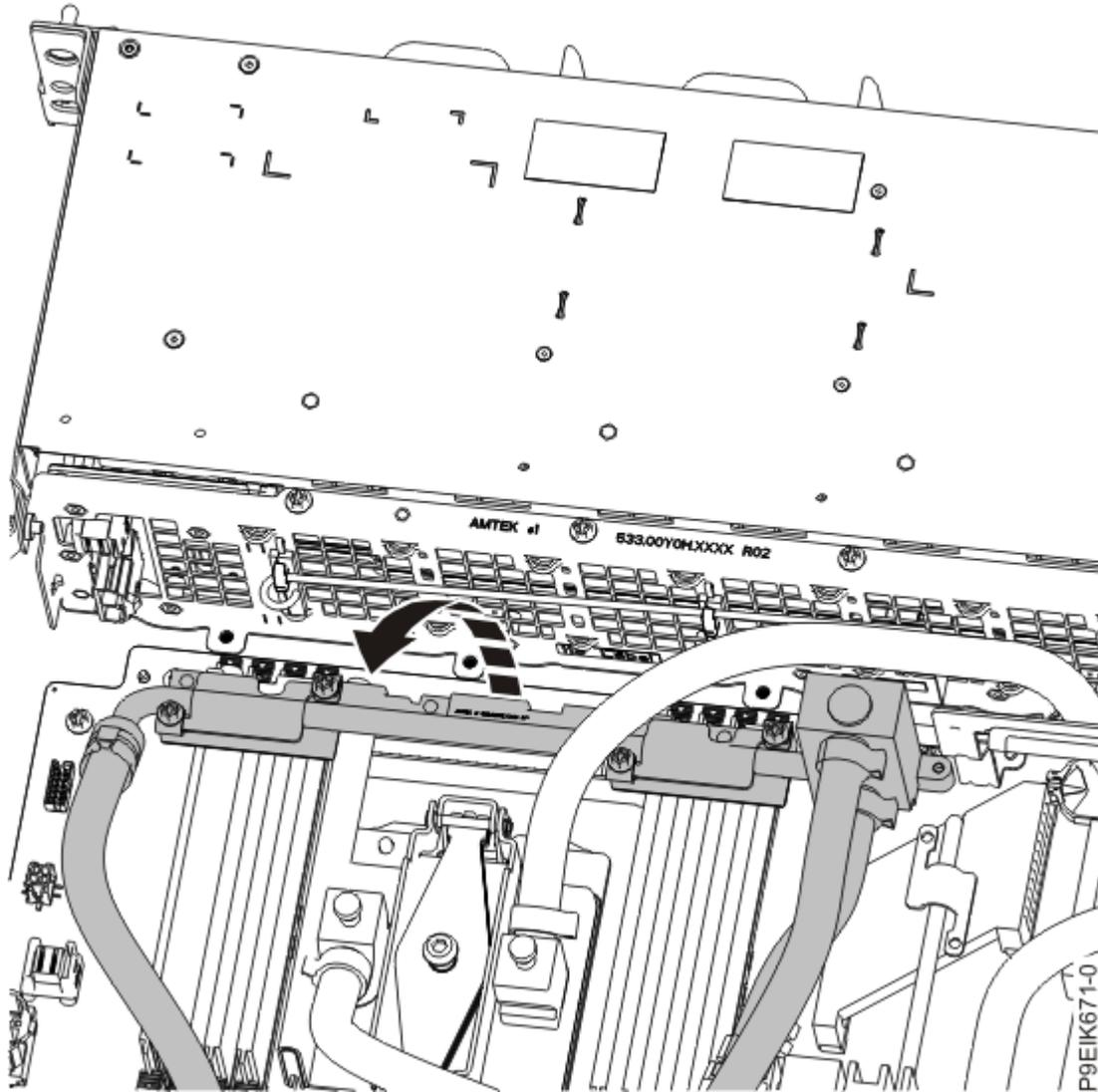
図 67. 前面パイプの移動
