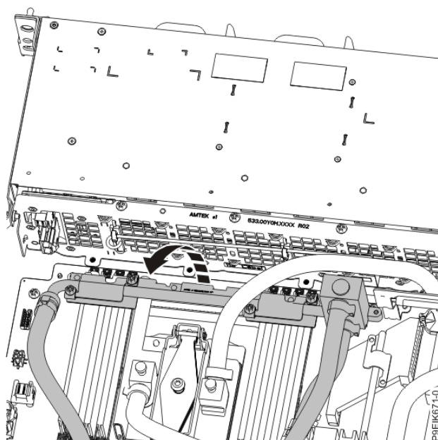
図 14. 前面パイプの移動
