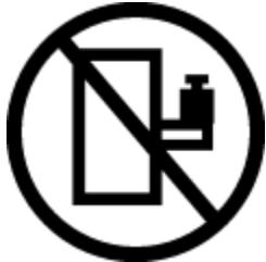
**危険:** ラック・マウント型デバイスを棚やワークスペースとして使用しないでください。ラックに搭載された装置の上にものを載せないでください。また、ラックに取り付けられた装置に寄り掛かったり、(はしごに乗って作業している場合などに) 体の位置を安定させるためにそれらの装置を使用したりしないでください。安定度の危険:
