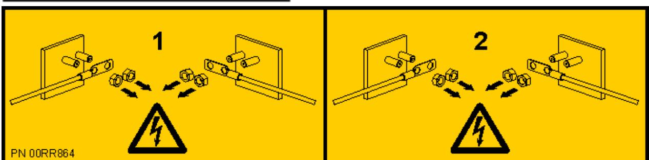
**危険:** 複数の電源コード。この製品は複数の AC 電源コードや複数の DC 電源ケーブルを備えていることがあります。危険な電圧をすべて除去するために、すべての電源コードと電源ケーブルを切り離してください。(L003)
