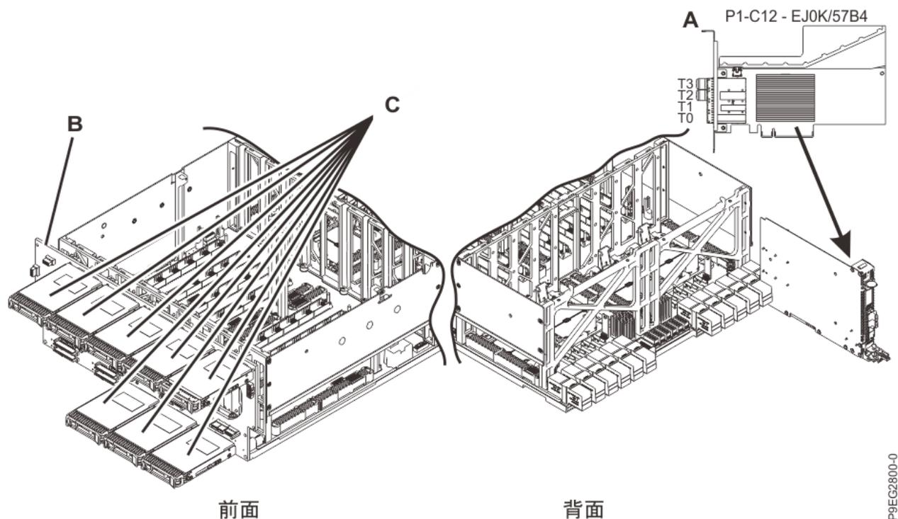
図 1. 基本機能ストレージ構成を使用する 9040-MR9 システム内の SAS サブシステム部品
