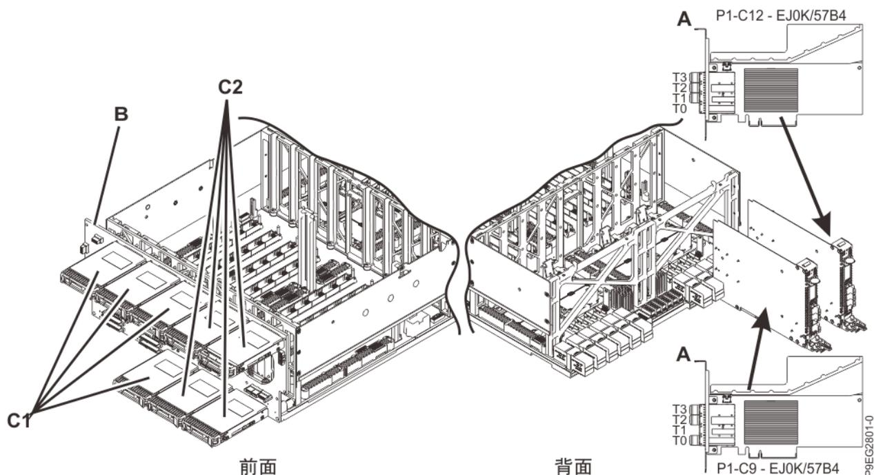
図 2. 分割ディスク・フィーチャーを搭載した基本機能ストレージ構成を使用する 9040-MR9 システム内の SAS サブシステム部品
