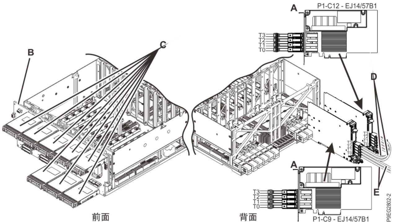
図 3. 拡張機能ストレージ構成を使用する 9040-MR9 システム内の SAS サブシステム部品
